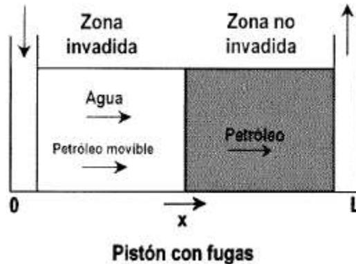
Figura 14: Modelo de desplazamiento tipo pistón con fugas.
