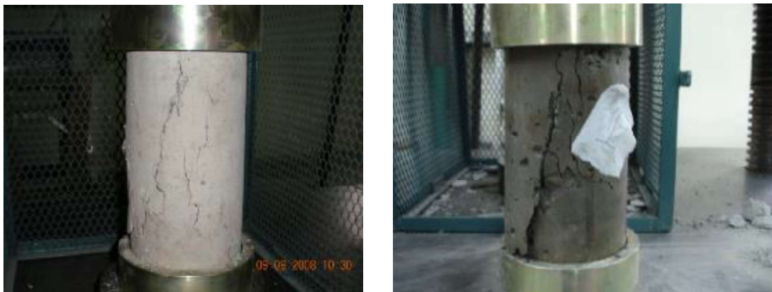
FIGURA 2.19 Muestra de fisuras encontradas con ensayos experimentales en especímenes de geometría cilíndrica.
