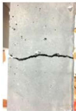
FIGURA 3.15 Patrón de fisura a tensión del hormigón no reforzado en espécimen tipo DogBone.
