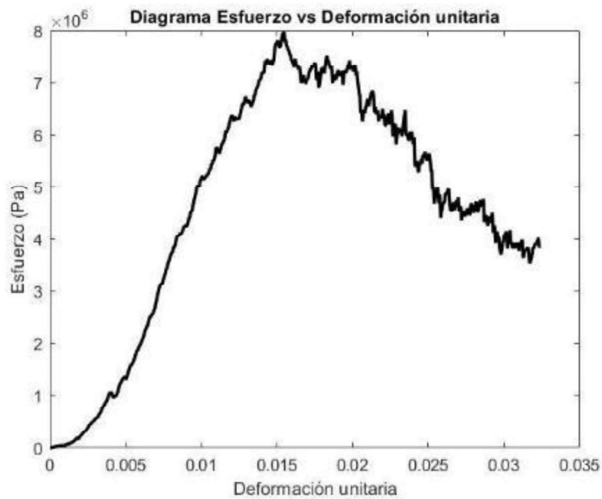
FIGURA 4.8 Diagrama Esfuerzo vs Deformación absoluta del modelo discreto del hormigón C.
