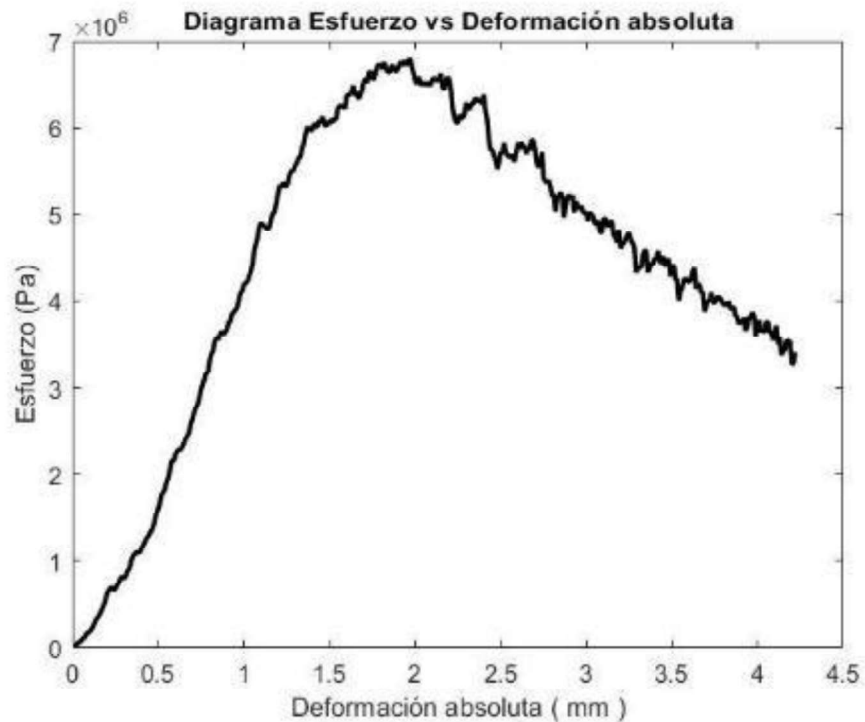
FIGURA 4.5 Diagrama Esfuerzo vs Deformación absoluta del modelo discreto del hormigón B.
