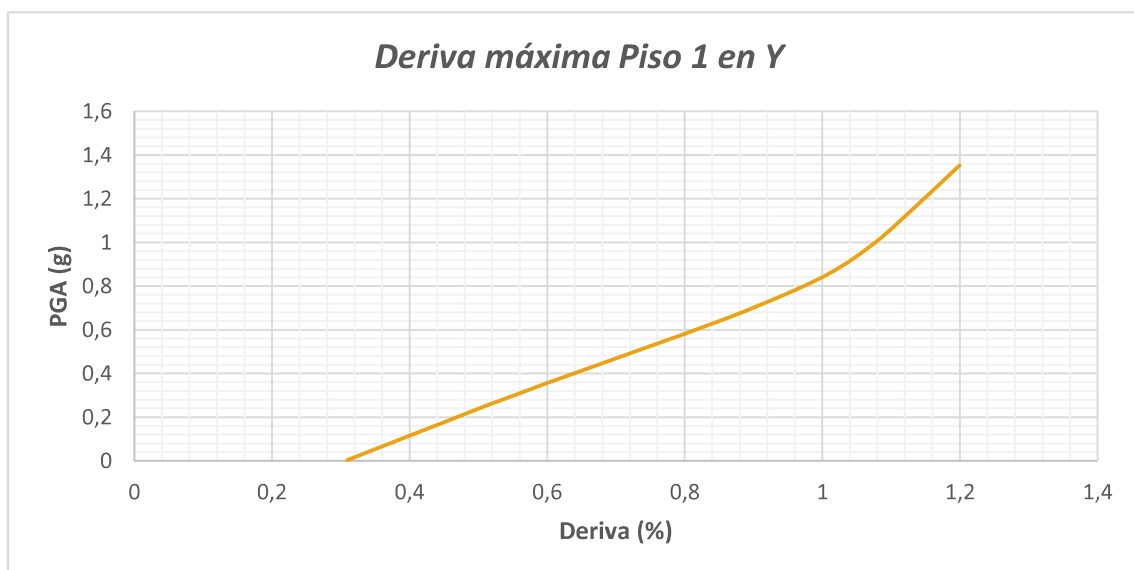
FIGURA 3.32 Curva IDA (PGA vs Deriva en Y) del Bloque B
