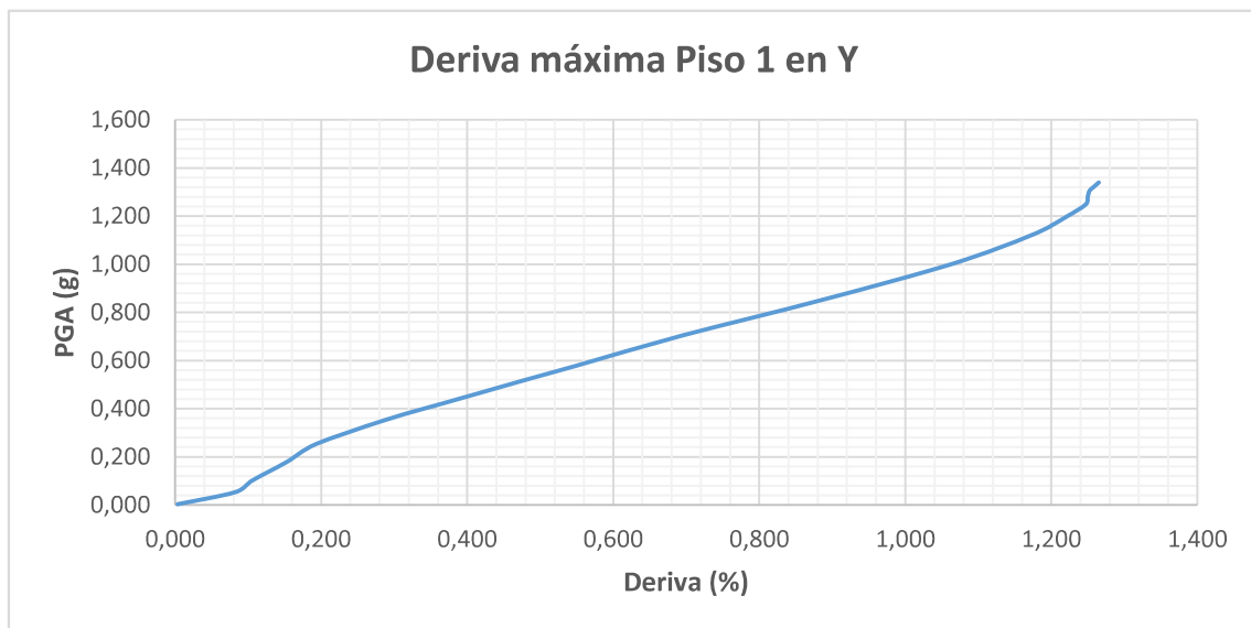
FIGURA 3.25 Curva IDA (PGA vs Deriva en Y) del Bloque A
