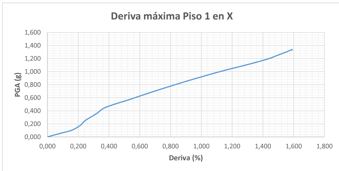
FIGURA 3.24 Curva IDA (PGA vs Deriva en X) del Bloque A
