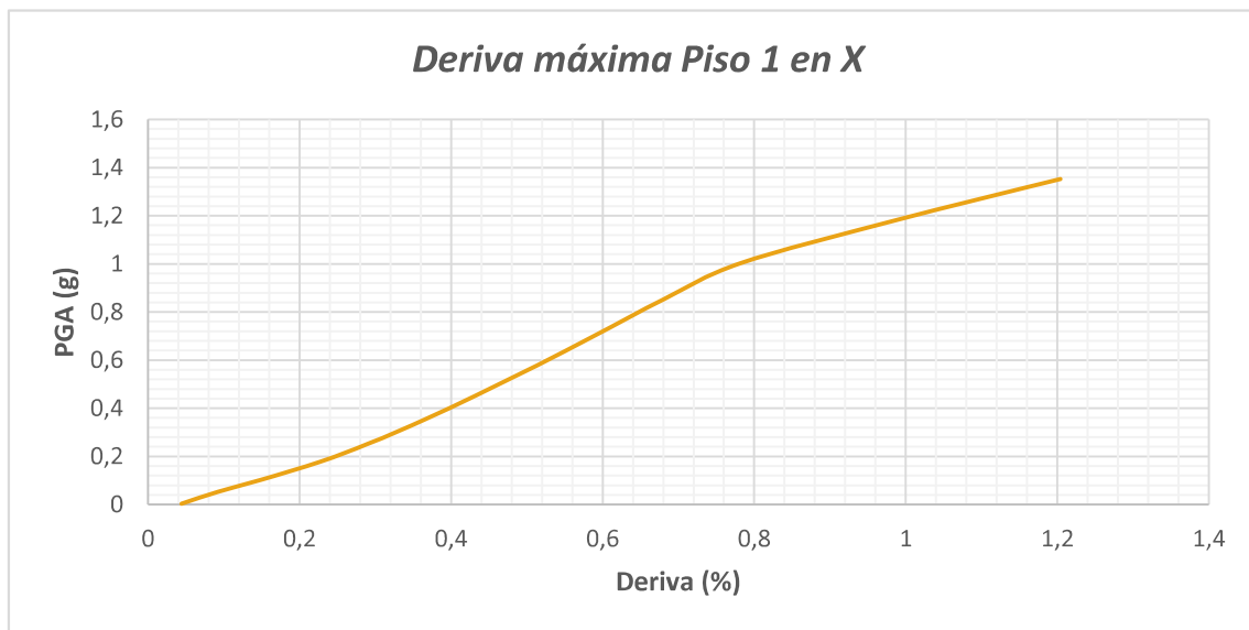
FIGURA 3.31 Curva IDA (PGA vs Deriva en X) del Bloque B
