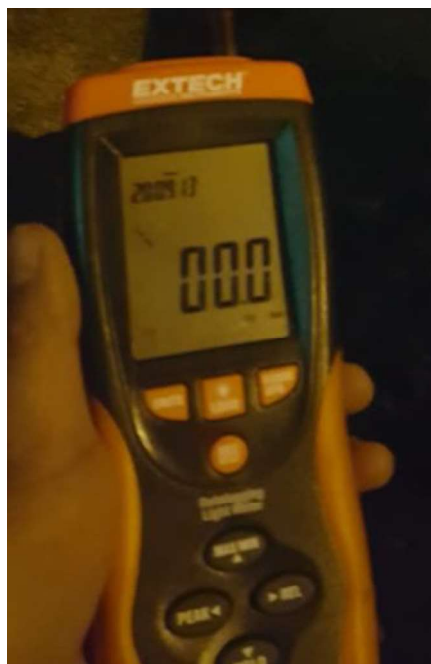
Figura 3.4 Medición de lux en el área antes de ser intervenida (00,0 lx)
