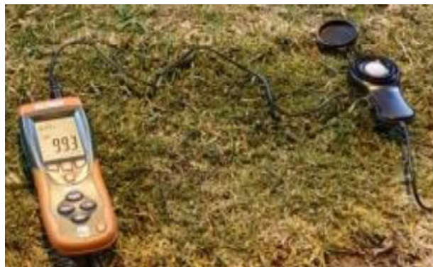
Figura 3.25 Medición después de implementar el proyecto (99,3 lx).
