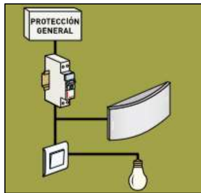
Figura 2.8. Conexión de iluminación de emergencia. (Legrand, 2019)
