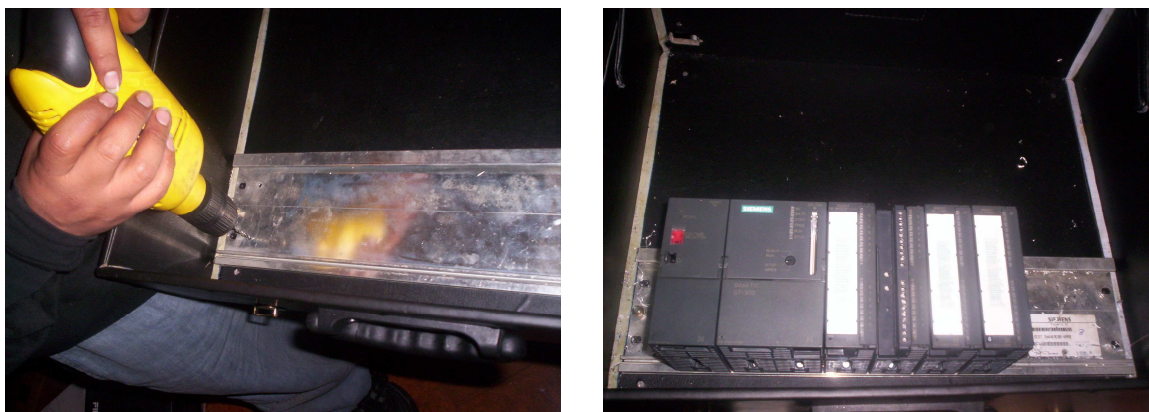
Gráfico 47: Instalación de la base con la maleta y el PLC.
