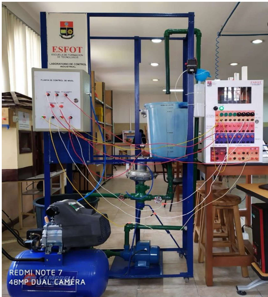
Figura 3.72 Prueba de funcionamiento de la Planta de control de nivel por presión hidrostática
