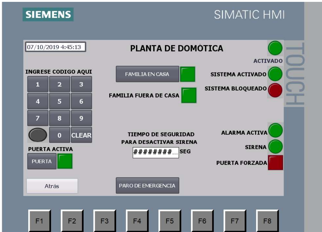
Figura 3.62 Pantalla principal de la planta de domótica en la pantalla táctil
