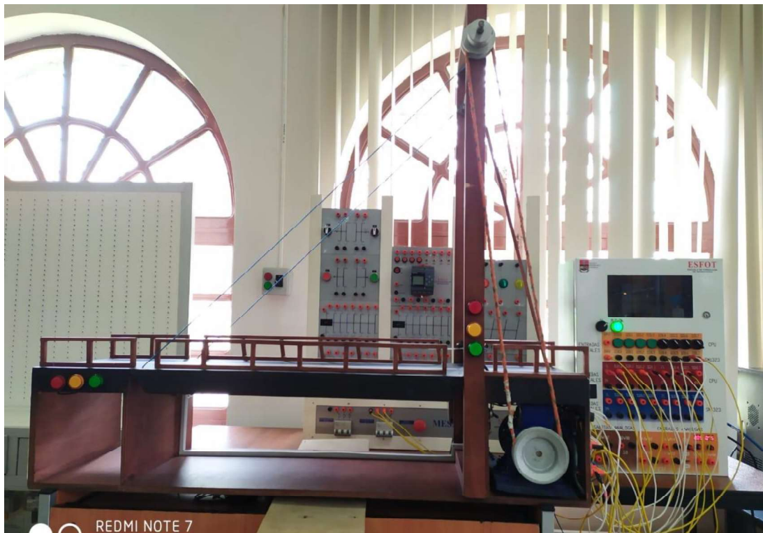
Figura 3.71 Prueba de funcionamiento de la Planta de control de puente levadizo
