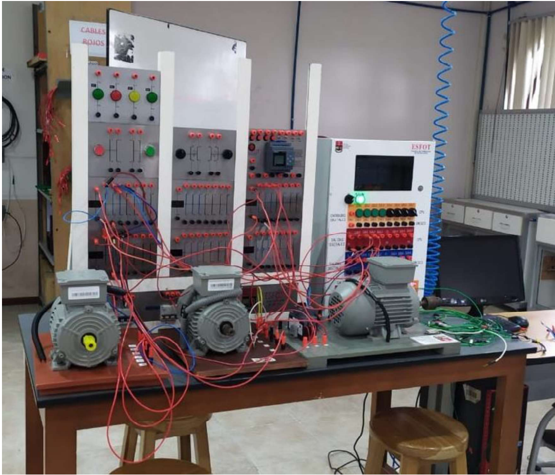
Figura 3.26 Módulo del accionamiento de motores
