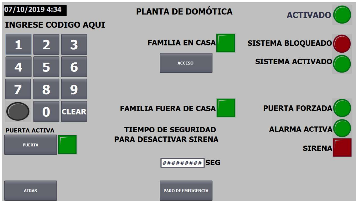
Figura 3.53 Pantalla principal de la interfaz de la planta de domótica en el ordenador
