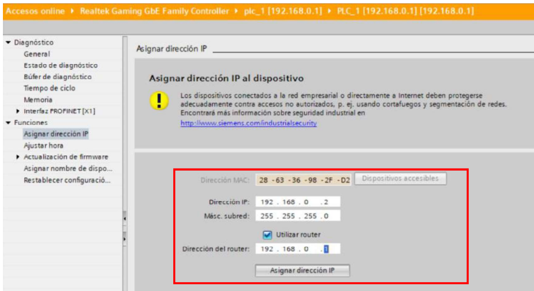
Figura 3.6 Colocación de la dirección IP del autómata
