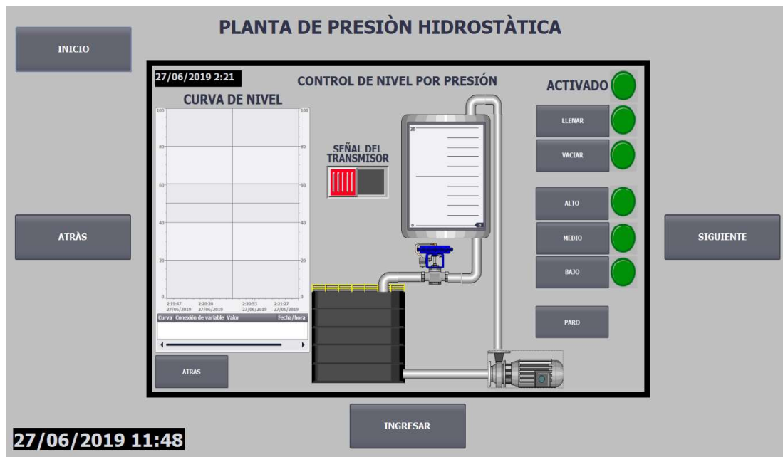
Figura 3.57 Pantalla principal de la planta de control de nivel por presión hidrostática en el ordenador
