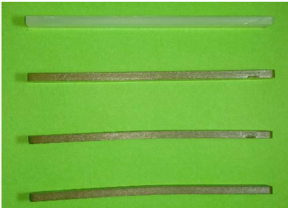
Figura 3.10. Probetas de biocompuesto de distintas composiciones después de ser sometidas a ensayo de flexión. De arriba hacia abajo respectivamente las muestras PP100, PP92-RH5-MAPP, PP82-RH15-MAPP, PP72-RH25-MAPP. (Fuente: Propia)
