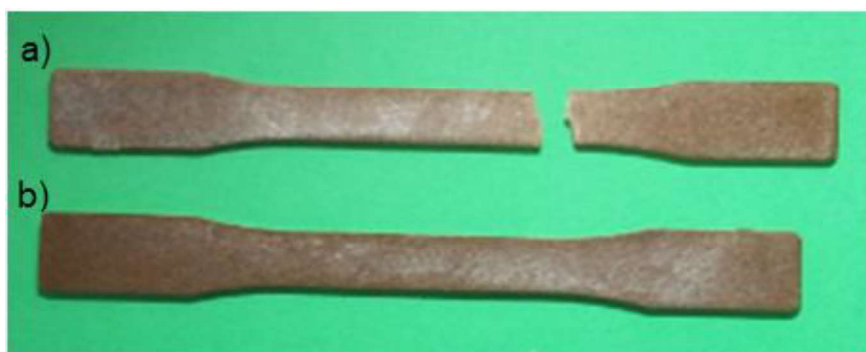
Figura 2.16. Probeta de tracción, a) ensayada, b) sin ensayar. (Fuente: Propia)
