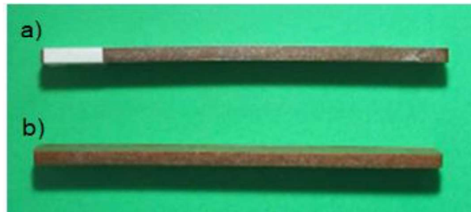
Figura 2.20. Probeta de flexión, a) ensayada, b) sin ensayar. (Fuente: Propia)
