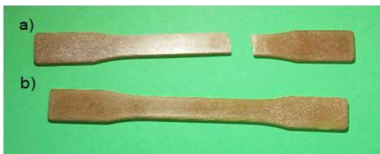
Figura 3.14. Probetas de biocompuesto sin MAPP sometida a tracción a) probeta ensayada, b) probeta sin ensayar. (Fuente: Propia)
