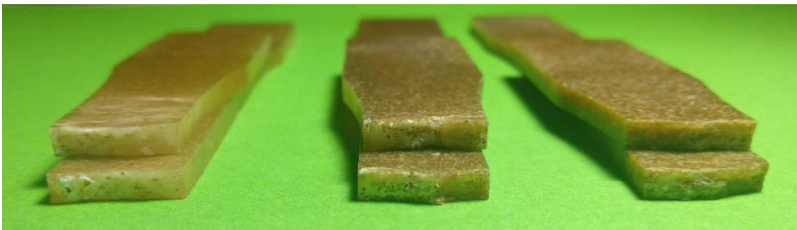
Figura 3.26. Fractura en probetas de biocompuesto sin MAPP, de izquierda a derecha PP95-RH5, PP85-RH15 y PP75-RH25. (Fuente: Propia)
