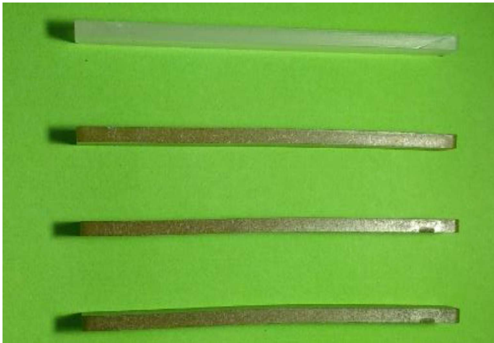
Figura 3.16. Probetas de biocompuesto de distintas composiciones después de ser sometidas a ensayo de flexión. De arriba hacia abajo respectivamente las muestras PP100, PP95-RH5, PP85-RH15, PP75-RH25. (Fuente: Propia)
