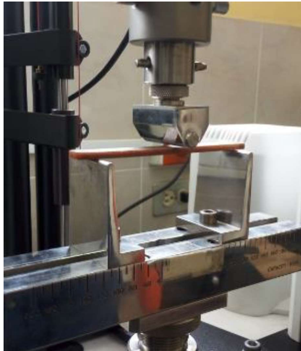
Figura 2.18. Encerado previo al ensayo de flexión. (Fuente: Propia)
