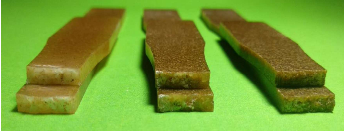
Figura 3.25. Fractura en probetas de biocompuesto con MAPP, de izquierda a derecha PP92-RH5-MAPP, PP82-RH15-MAPP y PP72-RH25-MAPP. (Fuente: Propia)
