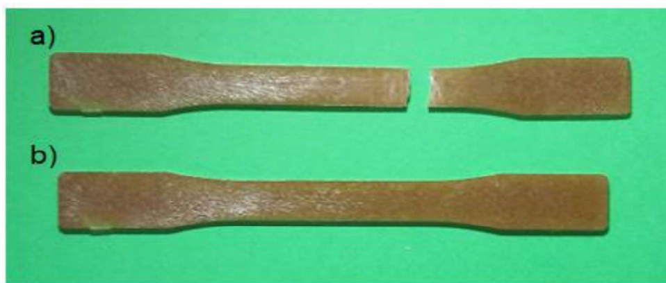
Figura 3.8. Probetas de biocompuesto con MAPP sometida a tracción a) probeta ensayada, b) probeta sin ensayar. (Fuente: Propia)
