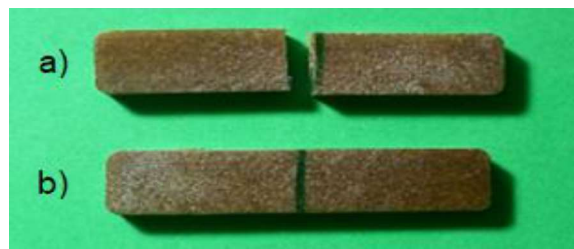
Figura 2.23. Probeta de impacto, a) ensayada, b) sin ensayar. (Fuente: Propia)
