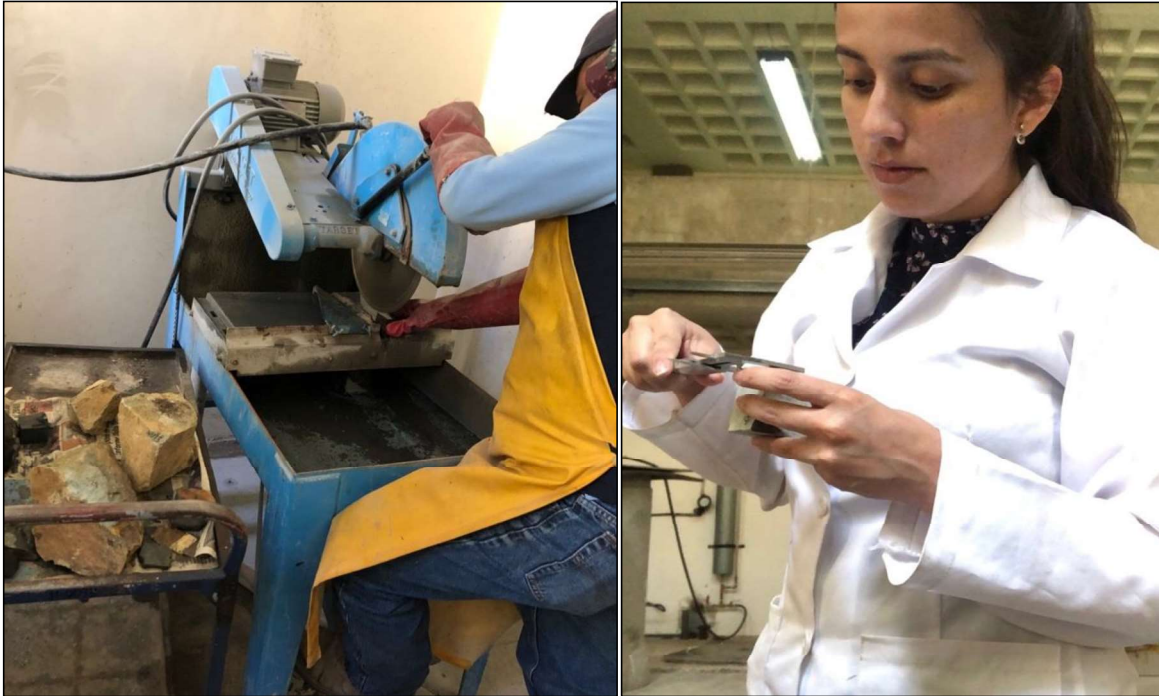
Fotografía 3.8 Corte y diseño de cubos para ensayo de compresión cúbica (izquierda). Toma de mediciones de bloque cúbico para realizar el ensayo (derecha).
