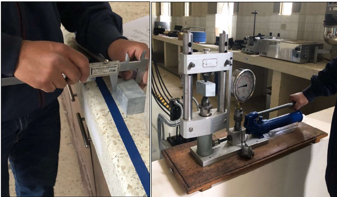
Fotografía 3.10 Toma de mediciones de un bloque para ensayo de carga puntual (izquierda). Realización de la prueba con la muestra correspondiente. (derecha).
