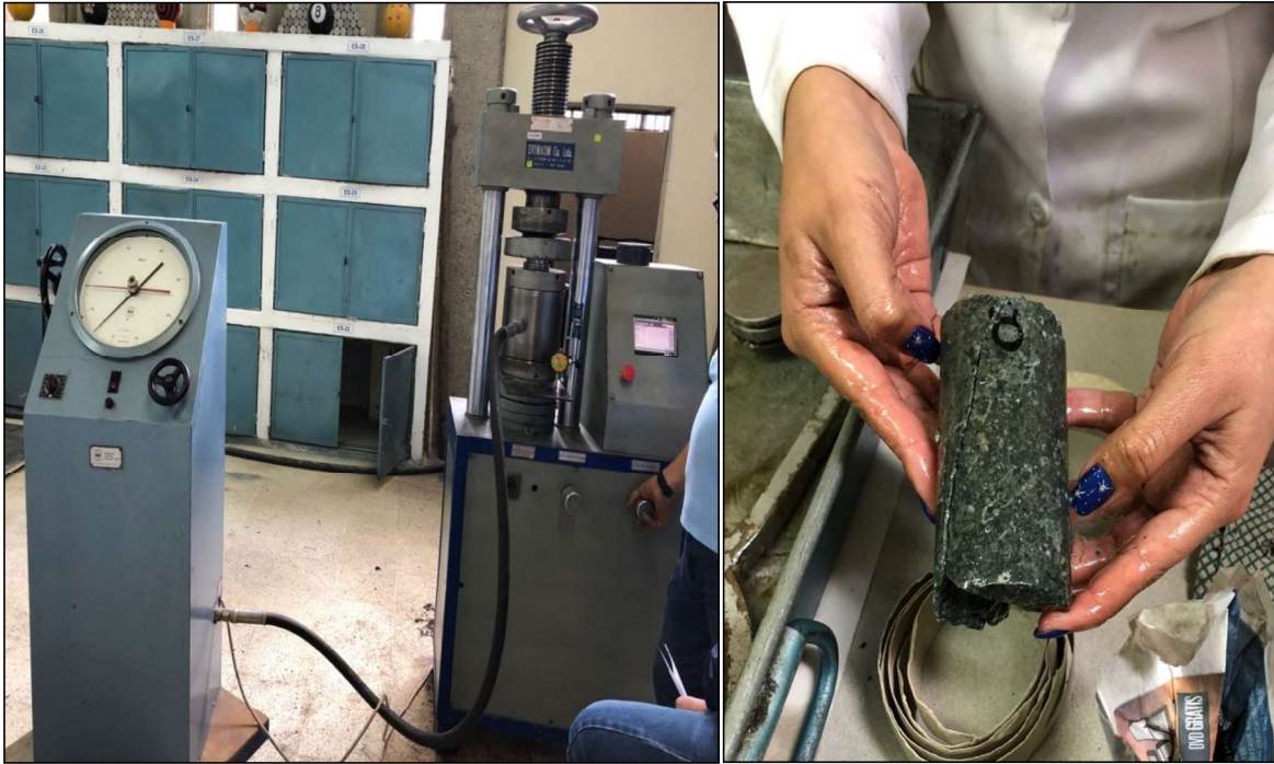
Fotografía 3.11 Máquina de ensayo triaxial y de regulador de presión (izquierda). Muestra ensayada con plano de rotura después de la prueba triaxial (derecha).
