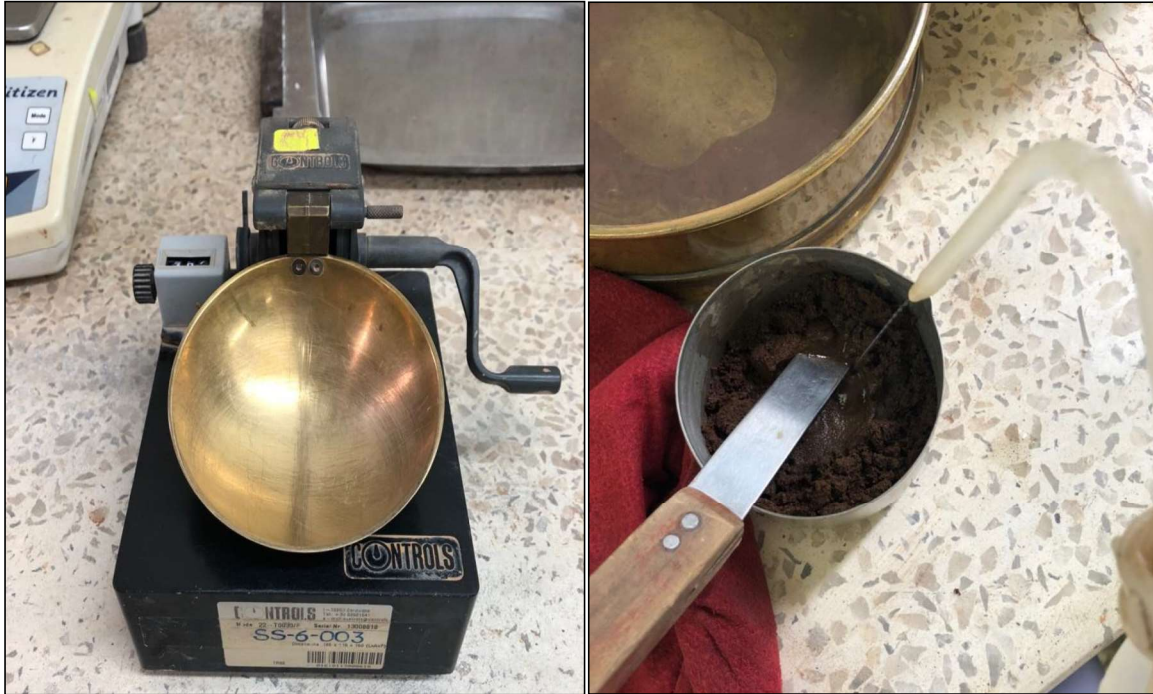
Fotografía 3.3 Copa Casagrande utilizada para determinar el límite líquido (izquierda). Preparación de la mezcla pastosa de suelo para realizar el ensayo (derecha).
