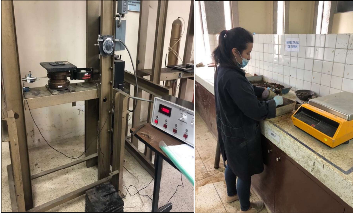
Fotografía 3.6 Máquina utilizada para la prueba de corte directo (izquierda). Preparación de los cilindros de suelo para realizar el ensayo corte directo (derecha).
