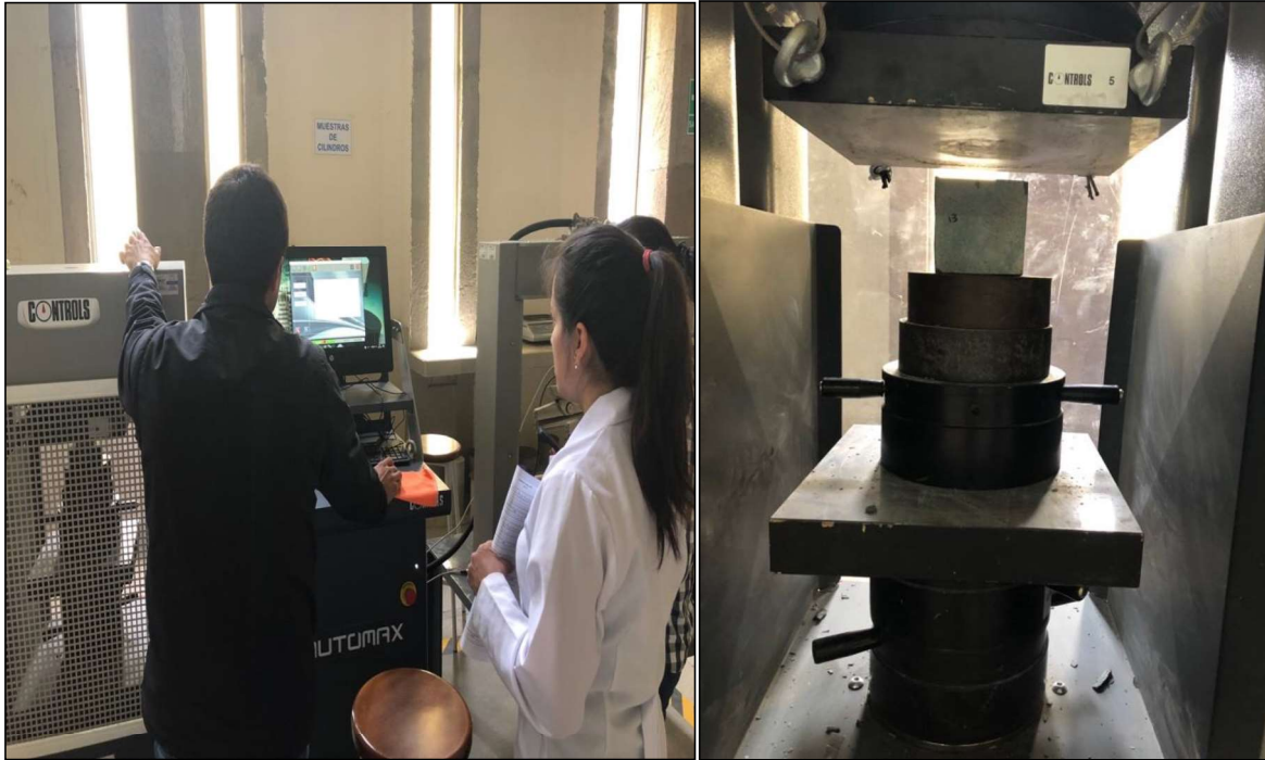
Fotografía 3.9 Máquina de RCS (izquierda). Muestra preparada para el ensayo de compresión cúbica (derecha).
