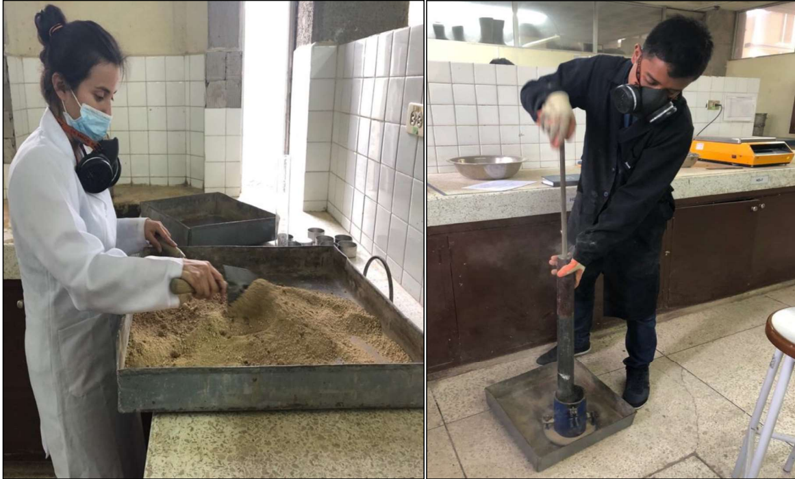
Fotografía 3.5 Elaboración de la mezcla de un determinado suelo (izquierda). Compactación de la mezcla correspondiente (derecha).
