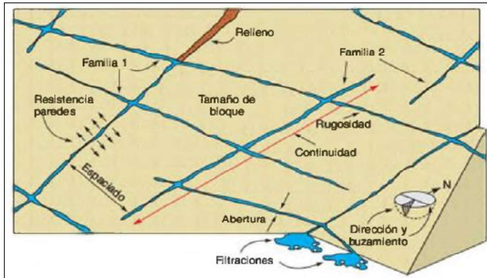
Figura 2.10 Representación gráfica de parámetros geomecánicos del RMR. Tomado de González de Vallejo, L., et al. (2002).
