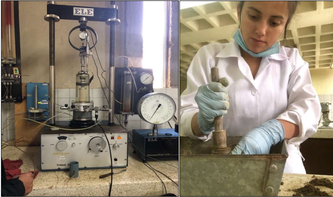
Fotografía 3.7 Máquina de ensayo triaxial en suelo en proceso (izquierda). Preparación de muestras cilíndricas para ensayo triaxial (derecha).
