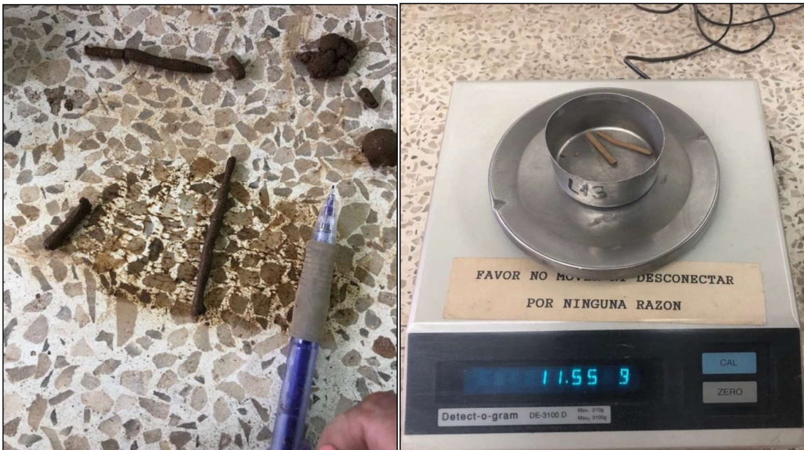
Fotografía 3.4 Amasamiento de filamentos para el ensayo límite plástico (izquierda). Peso de los filamentos después del secado al horno (derecha).
