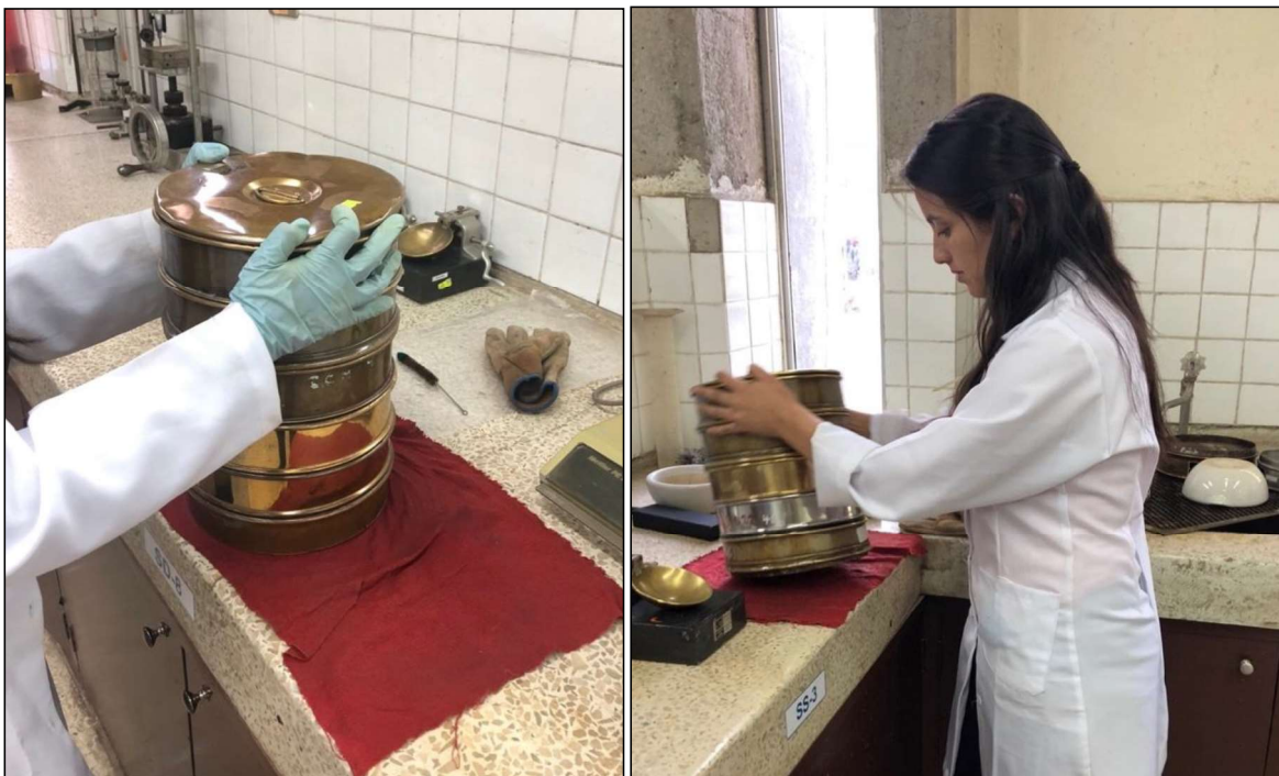
Fotografía 3.2 Tamices ordenados de mayor a menor abertura utilizados en el laboratorio (izquierda).
