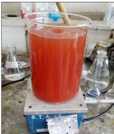
**Figura 11.** Proceso Fenton para el tratamiento de agua residual sintética con RR120.
