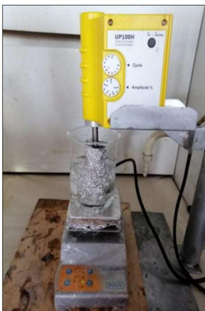
**Figura 14.** Proceso de ultrasonido previo a la fotocatalisis heterogénea para el tratamiento del agua residual sintética producto del rallado de yuca
