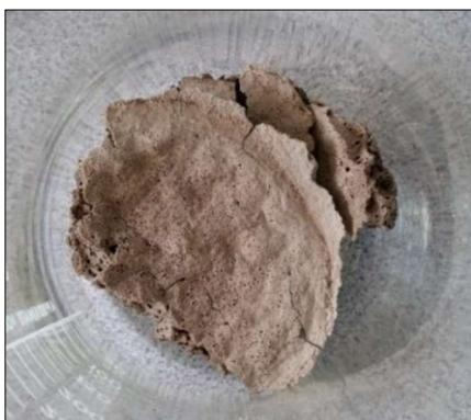
**Figura 13.** Compósito de Nitruro de Carbono grafítico.
