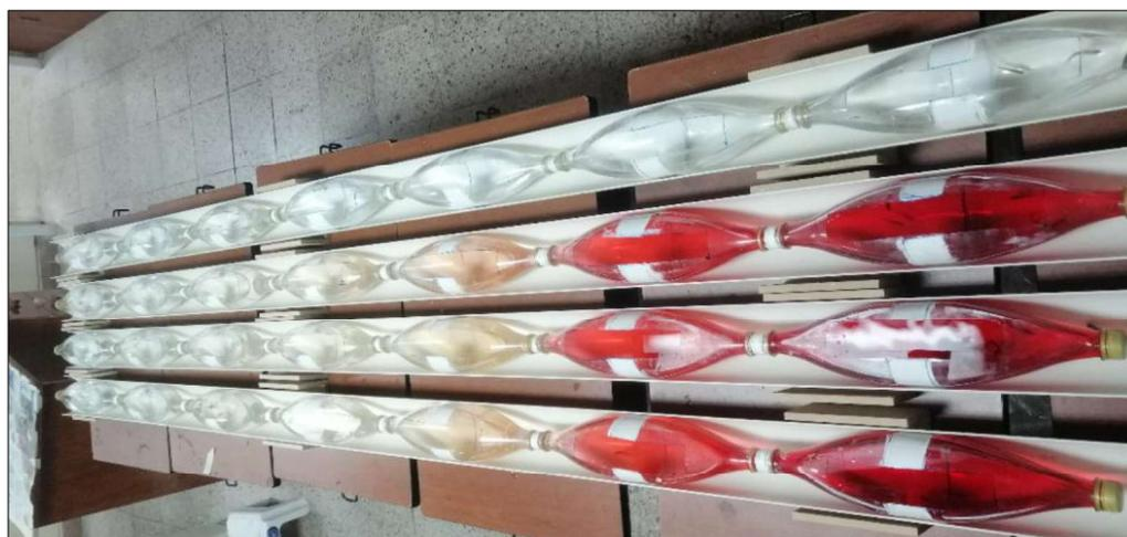
**Figura 16.** Ensayo de exposición no forzada con colorante RR120
