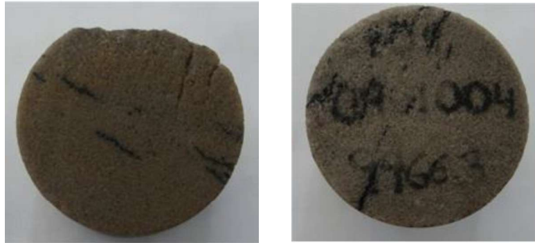
Figura 9. Nucleos de ensayo, Pozo-x1 , Reservoirio U (Fuente: Petroamazonas EP, 2015)
