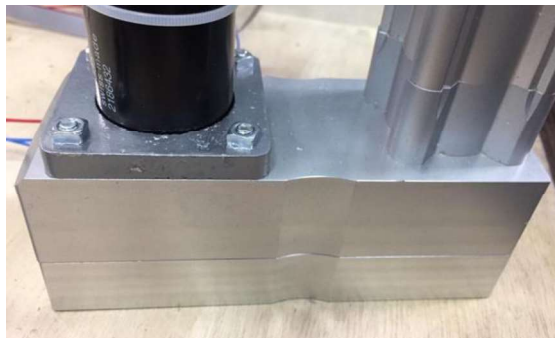
Figura 2.44. Conjunto paralelo ensamblado con el motor y el actuador. (Fuente: Autores)
