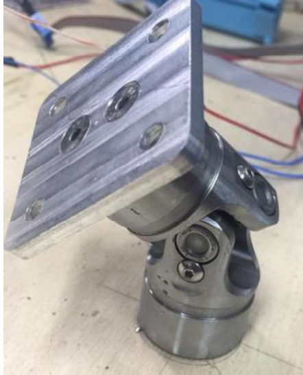
Figura 2.47. ensamblaje de la junta universal de las patas 1, 2 y 3. (Fuente: Autores)
