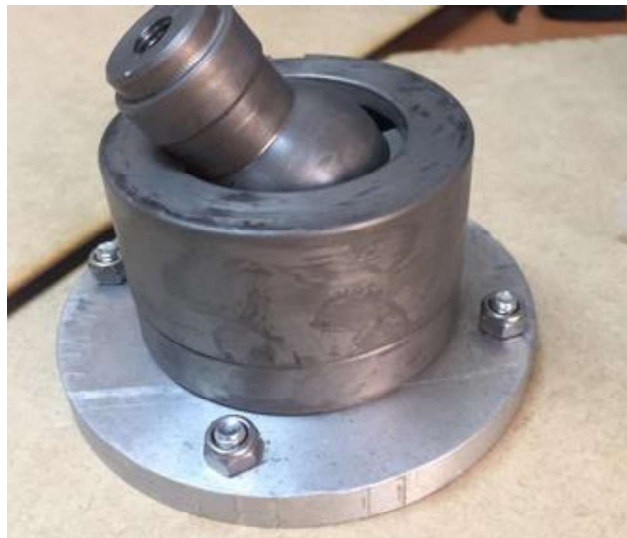
Figura 2.48. Ensamble de la junta esférica. (Fuente: Autores)
