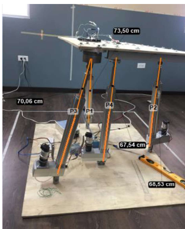
Figura 3.3. Posición de los actuadores lineales en el análisis para el movimiento de rotación interna y externa de rodilla con rotación \psi .
