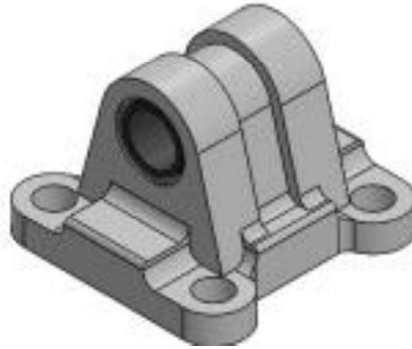
Figura 2.4. Brida basculante SNCL (Fuente: Autores)
