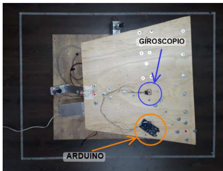
Figura 2.52. Elementos usados en la medición de movimientos alrededor de los ejes Y_m y Z_m . (Fuente: Autores)
