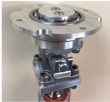
Figura 2.43. Junta universal de la pata 4. (Fuente: Autores)
