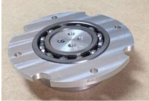
Figura 2.42. Ensamble de eje, rodamiento y chumacera. (Fuente: Autores)
