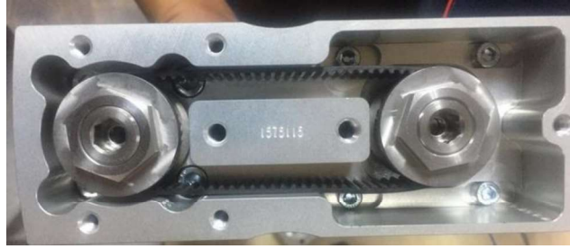
Figura 2.45. Elementos de transmisión del conjunto paralelo. (Fuente: Autores)
