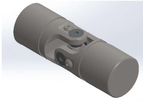
Figura 2.16. Dibujo 3D en SolidWorks de Junta universal Belden (Fuente: Autores)
