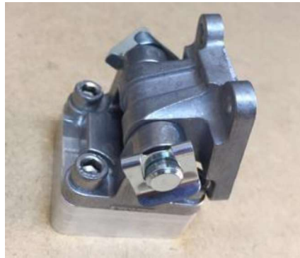
Figura 2.46. Ensamble de la junta de revolución de la pata 4. (Fuente: Autores)
