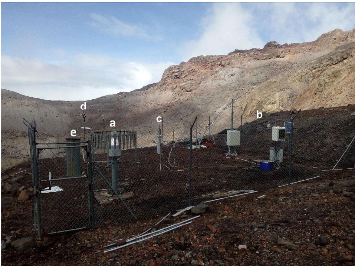
La Figura 2.3, muestra los instrumentos de la estación ORE: a) pluviógrafo de pesada marca Geonor, b) sonda ultrasonido, c) pluviógrafo de cangilones tipo HOBO, d) anemómetro-sensor de temperatura del aire y e) pluviómetro totalizador, utilizados en el presente estudio.
