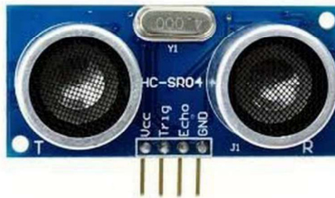
Figura 3. 14 Sensor ultrasónico HC-SR04
