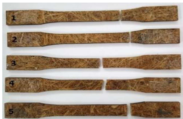
Figura V.2. Probetas ensayadas a tracción del compuesto reforzado con fibra corta no tratada.
