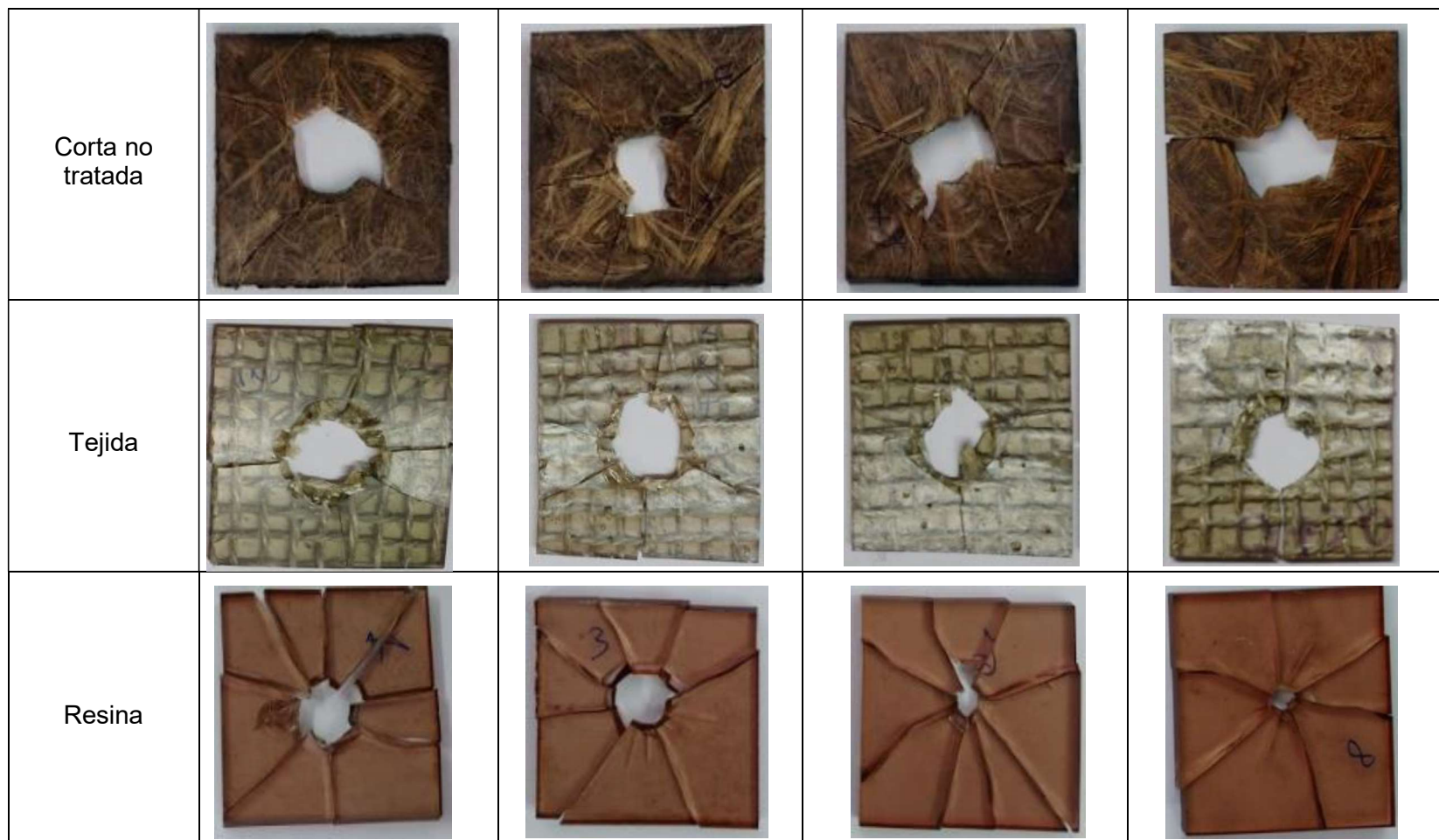
Figura XIII.1. Área de la ruptura de las probetas de material compuesto en el ensayo mecánico de impacto mediante caída de dardo.
