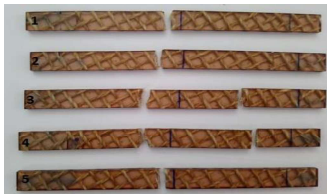
Figura VII.4. Probetas ensayadas a flexión del compuesto reforzado con tejido orientado a 30°.
