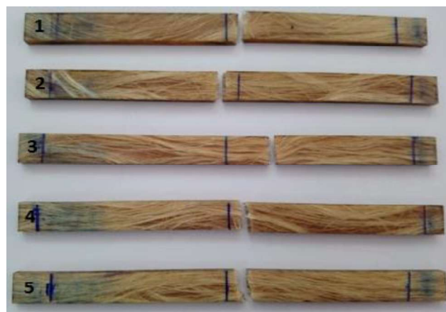
Figura II.4. Probetas ensayadas a flexión del compuesto reforzado con fibra continúa longitudinal tratada.
