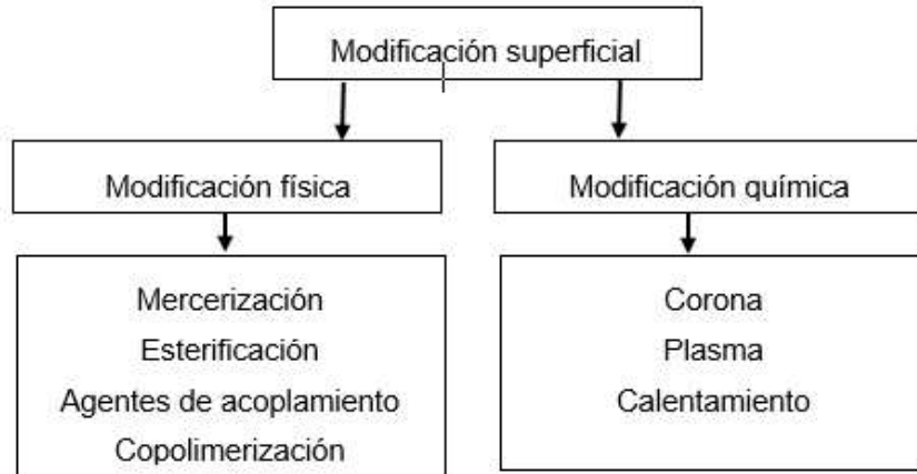
Figura 1.13. Métodos de modificación de superficie. (Fuente: (Pickering, 2008))
