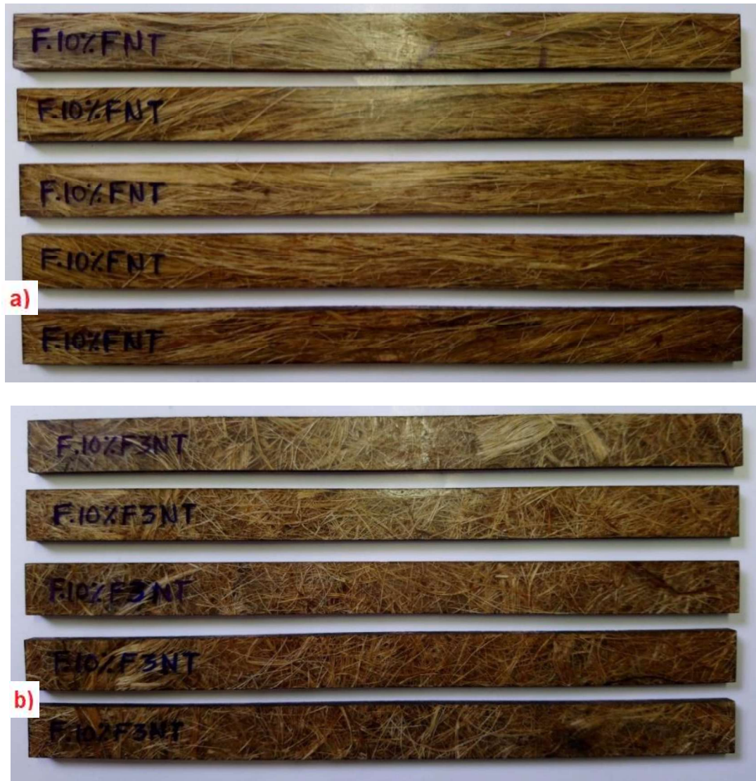
Figura 2.9. Probetas del material compuesto para ensayo de flexión con fibra no tratada: a) continua longitudinal, b) corta aleatoria.
