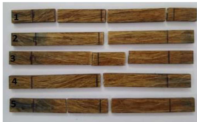
Figura III.4. Probetas ensayadas a flexión del compuesto reforzado con fibra continua longitudinal no tratada.
