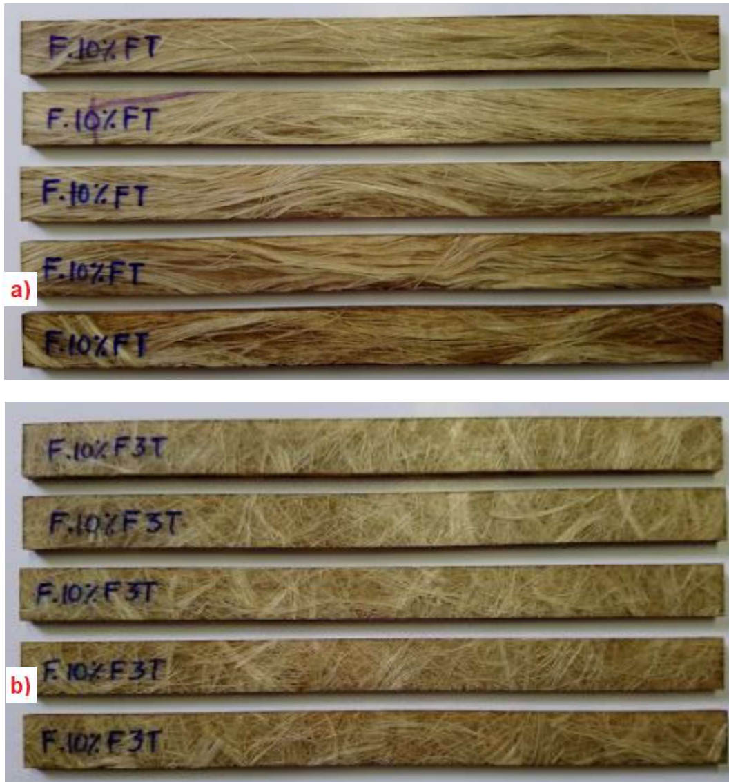
Figura 2.11. Probetas del material compuesto para ensayo de flexión con fibra tratada: a) continua longitudinal y b) corta aleatoria.
