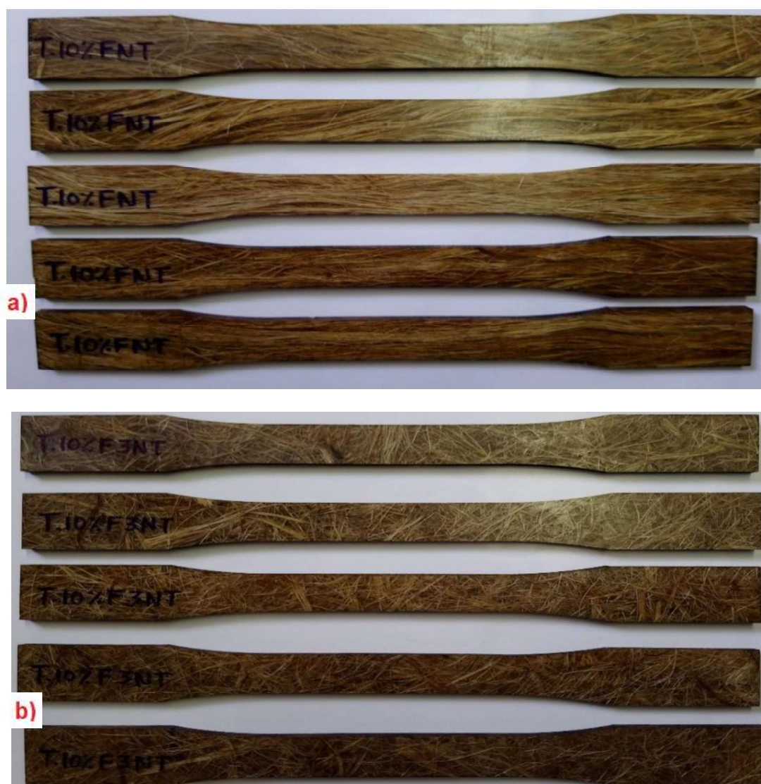
Figura 2.8. Probetas del material compuesto para ensayo de tracción con fibra no tratada: a) continua longitudinal, b) corta aleatoria.
