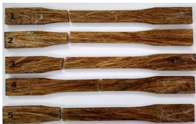
Figura III.2. Probetas ensayadas a tracción del compuesto reforzado con fibra continua longitudinal no tratada.
