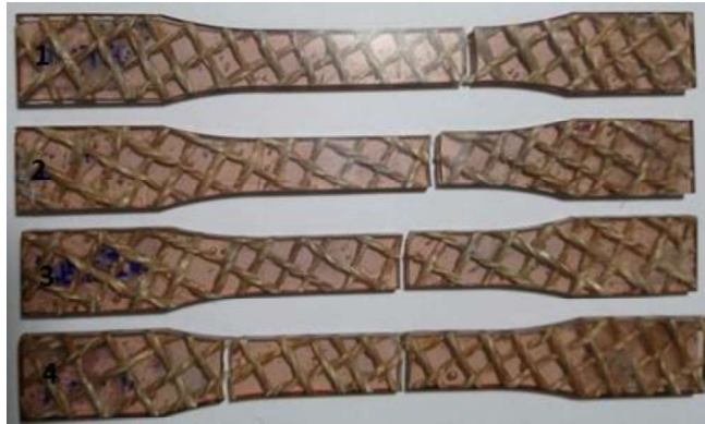
Figura VI.2. Probetas ensayadas a tracción del compuesto reforzado con tejido orientado a 30°.
