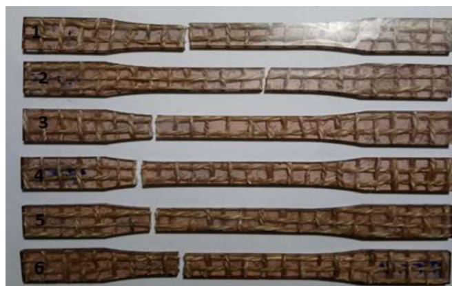
Figura VI.2. Probetas ensayadas a tracción del compuesto reforzado con tejido orientado a 0°.
