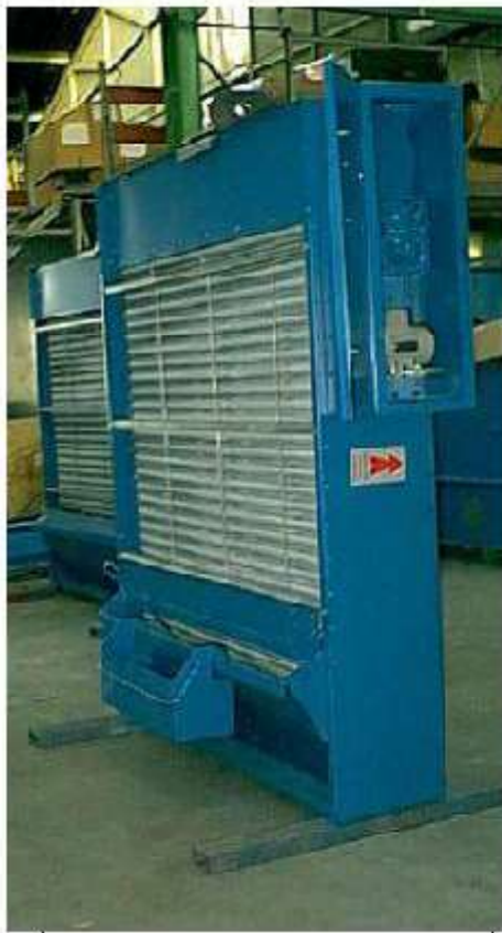
Figura 3.8. Sistema automático de filtro con persianas húmedas (Fuente. Manual del fabricante Wartsila W16V32)
