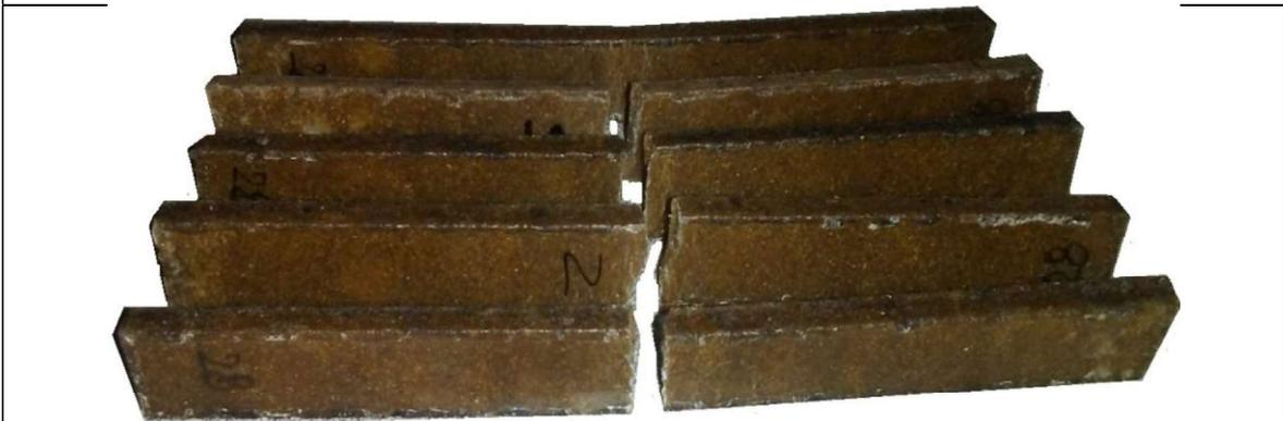
Probetas PP\_15CA\_T60: El 80% de los especímenes obtuvieron una deformación del 3,46%, esta composición tiene los valores más bajos de las propiedades con respecto a las probetas del tamiz número 60, también se puede apreciar un cambio de coloración en el lugar de la ruptura.
