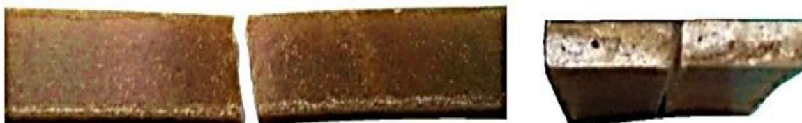
Figura 3. 38. Defectos encontrados en las probetas de flexión tras su ruptura.
