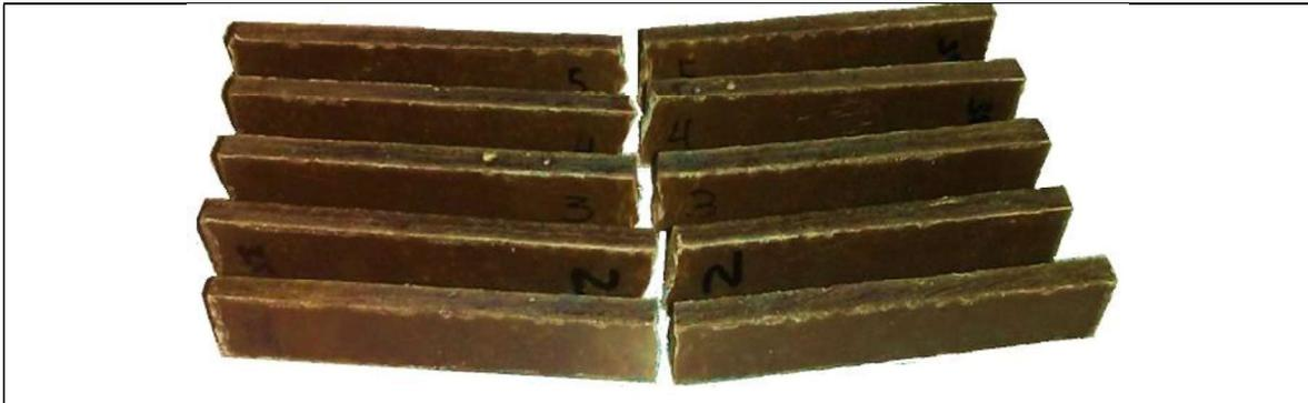
Probetas PP\_10CA\_T140: Existió una deformación del 3,27% de los especímenes antes de llegar a la fractura, se puede apreciar que el 100 % de los especímenes se fracturaron, en la zona de ruptura existió un cambio de coloración, también se puede concluir que el material compuesto no tuvo una constitución uniforme.
