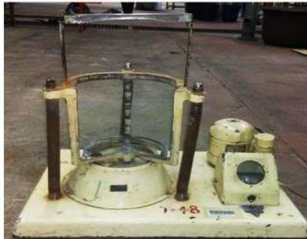
Figura 2. 4. Sacudidor de tamices (laboratorio de operaciones unitarias FIQA)
