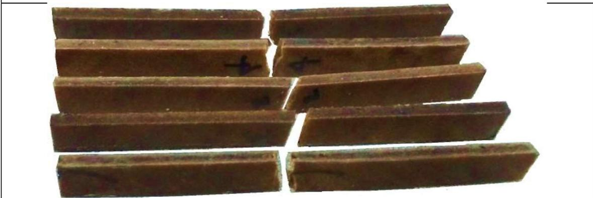
Probetas PP\_15CA\_T100: En esta composición se observa que las probetas poseían un acabado superficial liso sin ninguna discontinuidad, pero, al momento de someter los especímenes a esfuerzos todos se fracturaron, siendo esta la única composición del tamiz número 100 en fracturarse, alcanzando una deformación máxima de 3,14%.
