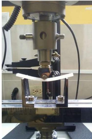
Figura 2. 23. Posicionamiento probetas de flexión
