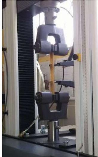
Figura 2. 22. Posicionamiento de la probeta
