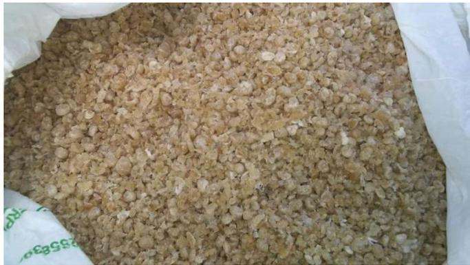
Figura 2. 19. Pellets de material compuesto
