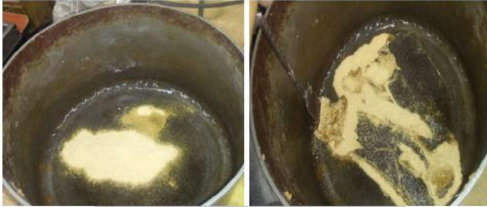
Figura 2. 16. Adición del refuerzo y mezcla de los componentes
