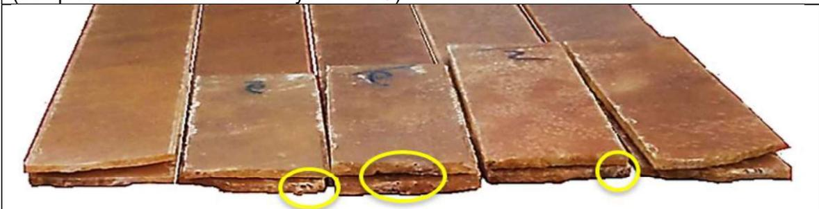
Probetas PP\_5CA\_T100: superficialmente las probetas no presentaban ningún defecto, sin embargo, al someterlas a esfuerzos de tensión los especímenes fallaron cerca de la mordaza móvil de la maquina universal de ensayos. En el caso de esta composición el número de defectos fue pequeño debido a que con una cantidad menor de material de refuerzo permitió una mejor unión entre refuerzo y matriz.
