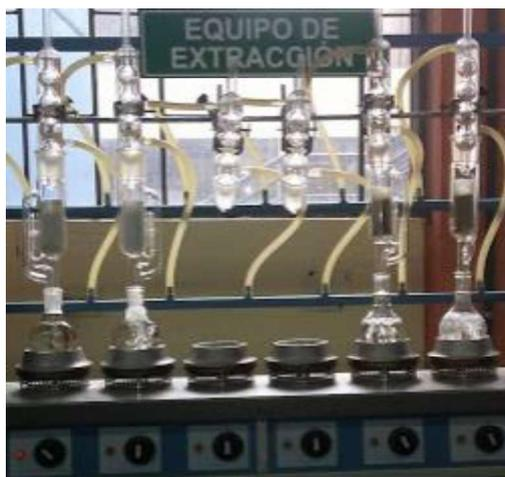
Figura 2. 10. Equipo de extracción Soxhlet
