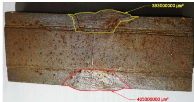
Figura 3.18: Área total de los dos lados correspondientes a la probeta TR, corte transversal. (Fuente: Propia)
