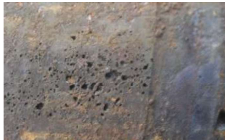
Figura 1.10: Representación de picadura en una placa de metal. (Fuente: García, 2016)
