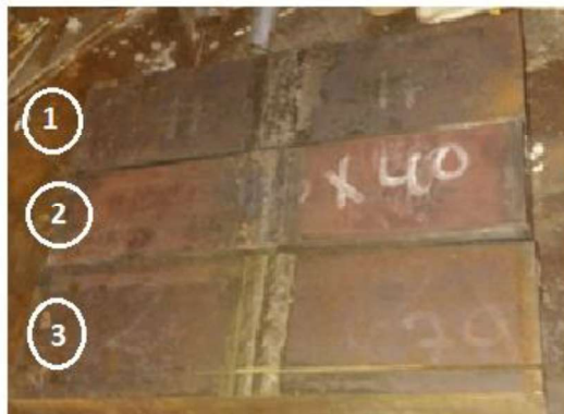
Figura 2.1: Placas soldadas y tratadas térmicamente. 1) Placa con tratamiento recocido. 2) Placa sin tratamiento 3) Placa con tratamiento térmico para aliviar tensiones residuales.
