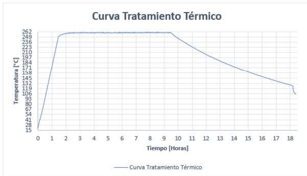
Figura 2.8. Curva del Tratamiento Térmico de Revenido. (Fuente: Propia)
