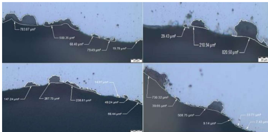
Figura 3.12: Área de corrosión los dos lados correspondientes a la probeta ST, corte transversal. (Fuente: Propia)
