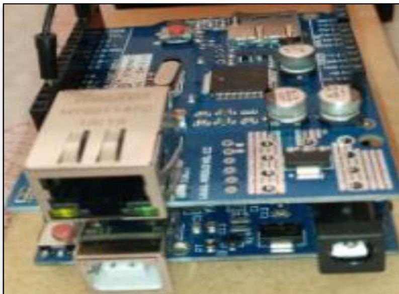
**Figura 3.20 Conexión de la placa *Ethernet Shield* en la placa Arduino Uno.**
