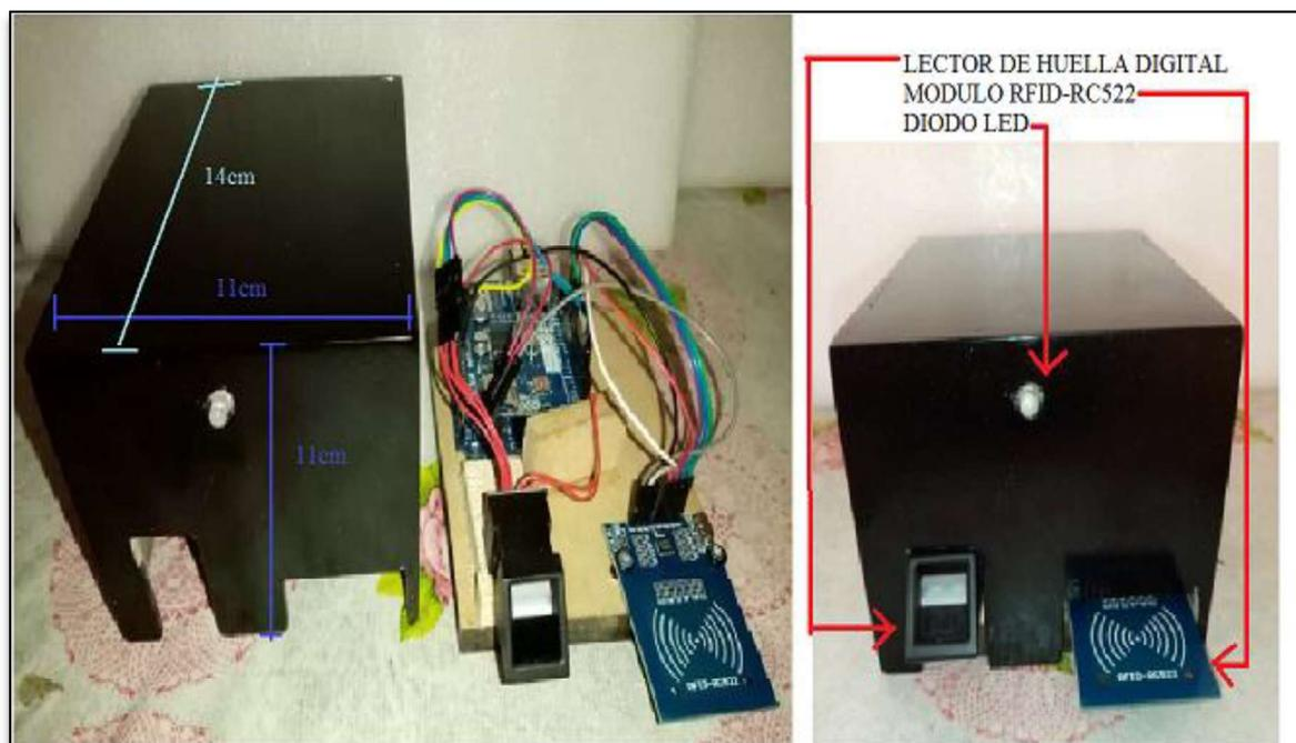
Figura 3.44 Caja del cliente 1 con su respectivo montaje.
