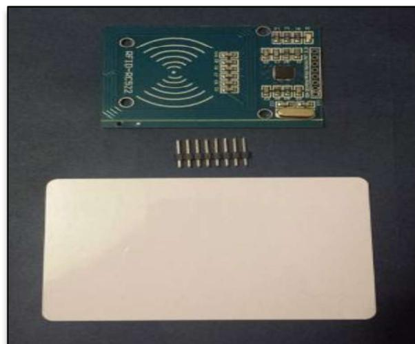
**Figura 3.4 Módulo RFID-522 y Tag RFID.**
