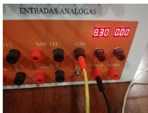
Figura 3.91: Voltaje mínimo de la señal del transmisor
