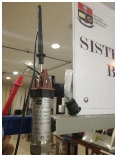
Figura 3.83: Conexión del amperímetro digital al transmisor
