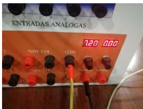
Figura 3.91: Voltaje mínimo de la señal del transmisor
