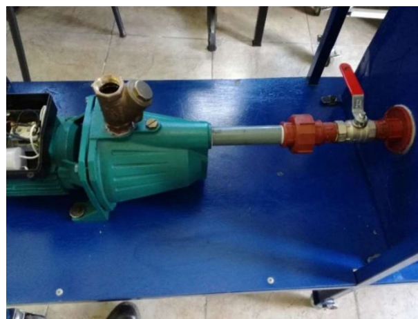
Figura 3.60: Fijación de la bomba a la estructura
