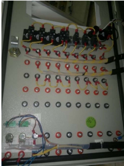
Figura 3.48: Conexión eléctrica de la parte frontal
