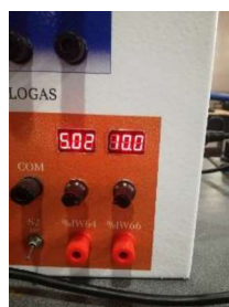
Figura 3.104: Prueba de entradas analógicas mediante potenciómetro
