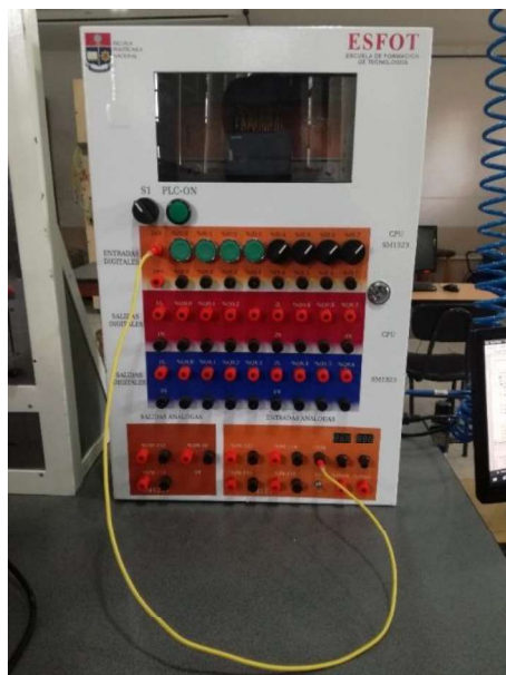
Figura 3.99: Pruebas de dispositivos de protección del módulo PLC
