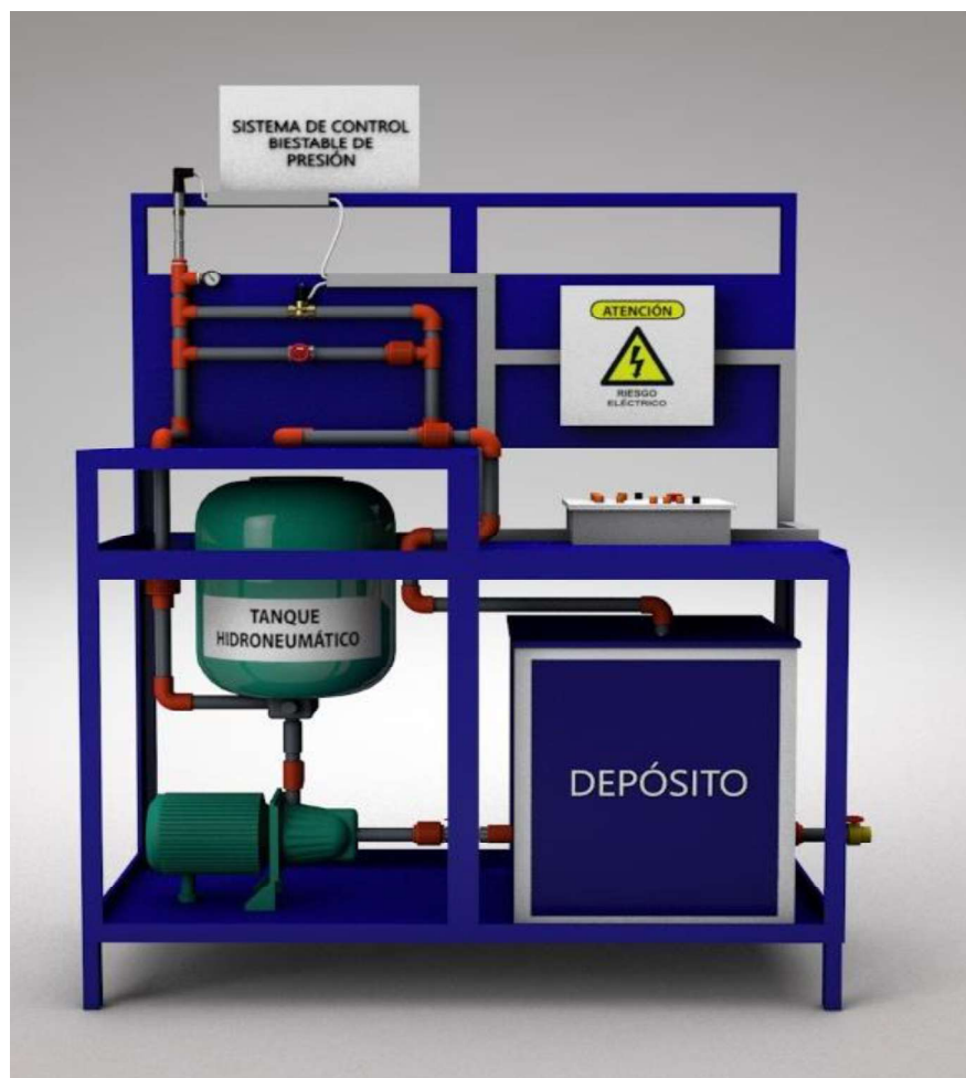
Figura 3.51: Diseño del sistema biestable de presión (vista frontal)
