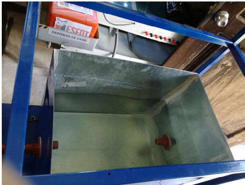
Figura 3.59: Fijación del depósito en la estructura
