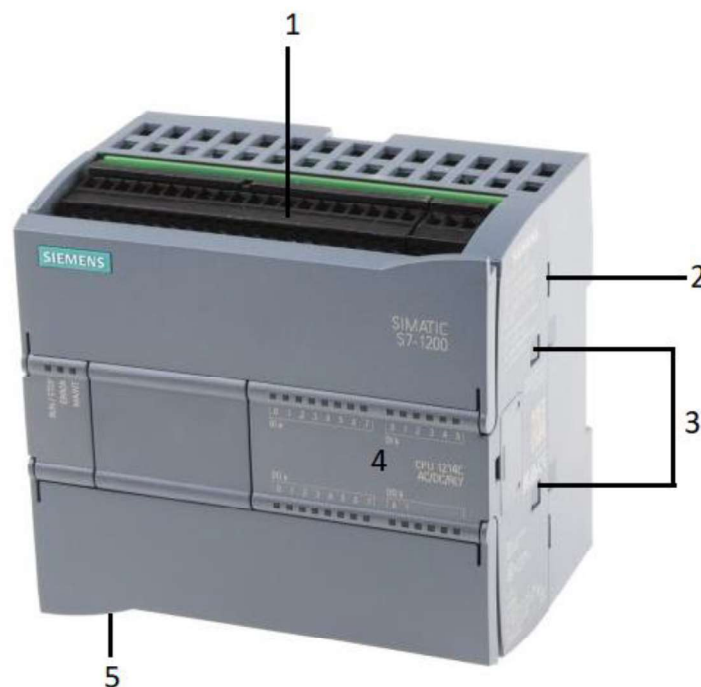
Figura 3.3: Estructura PLC S7-1200
