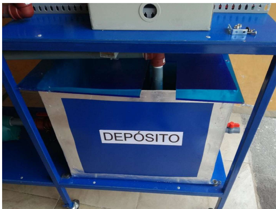
Figura 3.79: Instalación de la tapa en el depósito
