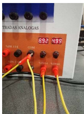
Figura 3.102: Prueba de entradas analógicas mediante fuente variable
