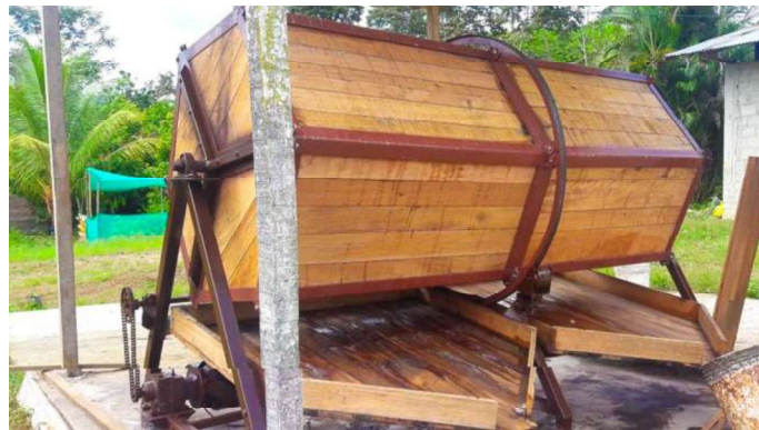
Figura 1.20. Fermentador rotatorio tipo Hexagonal. (Fuente: (S Coral, 2019))
