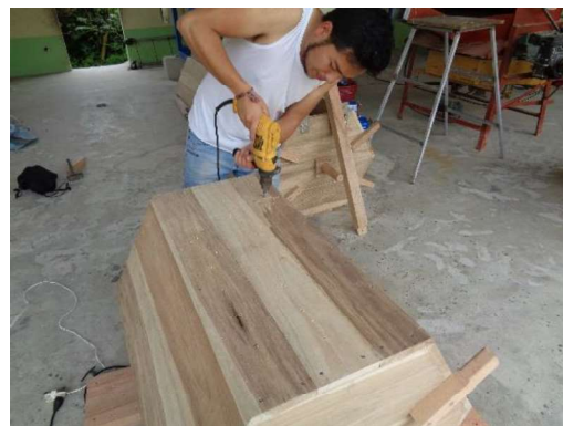
Figura 2.37. Realización de agujeros para el drenaje. (Fuente: Propia)
