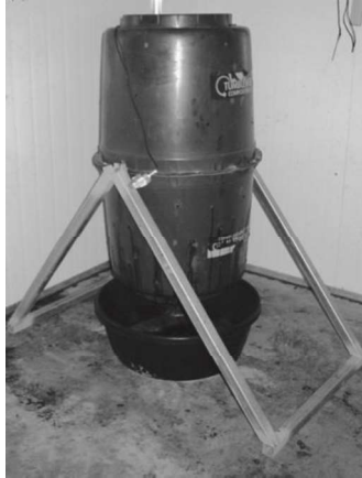
Figura 1.18. Fermentador rotatorio tipo vaso. (Fuente: (Schwan & Fleet, 2015))
