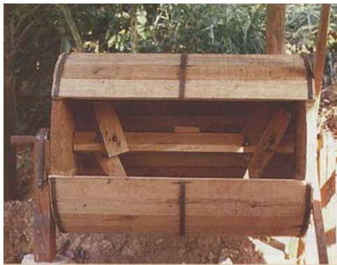
Figura 1.19. Fermentador rotatorio tipo barril. (Fuente: (Espinoza, 1998))
