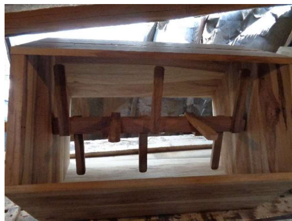
Figura 2.33. Construcción y colocación de las paletas.
