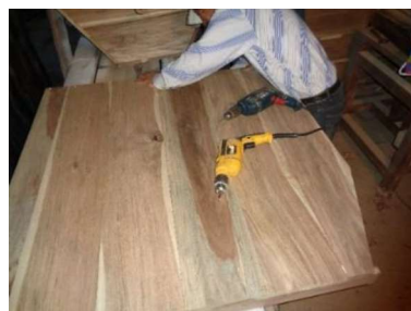
Figura 2.31. Construcción de la bandeja. (Fuente: Propia)
