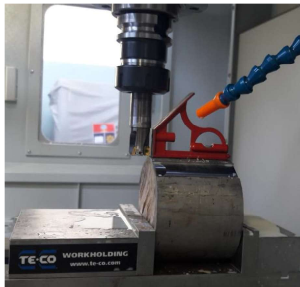
Figura 2.12. Nivelación de superficie previa operación de maquinado. (Fuente: propia)
