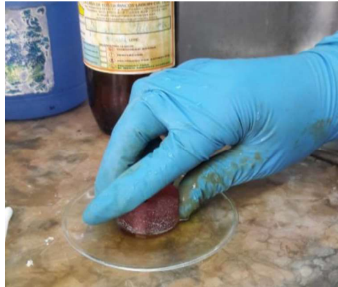
Figura 2.23. Ataque químico a la superficie de las probetas. (Fuente: propia)
