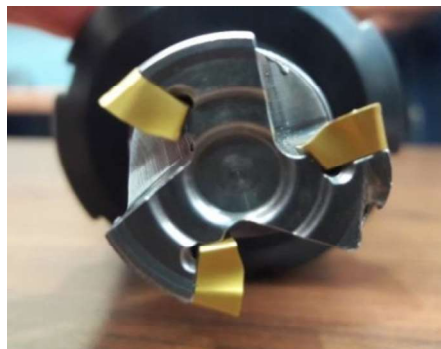
Figura 2.10. Insertos colocados y ajustados en el portaherramientas. (Fuente: propia)
