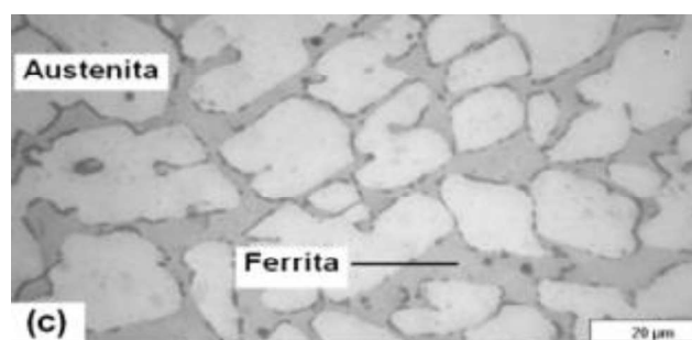
Figura 3.4. Microestructura característica de un acero dúplex. (Fuente: Gregorutti, Grau, Desimoni, & Elsner, 2011)
