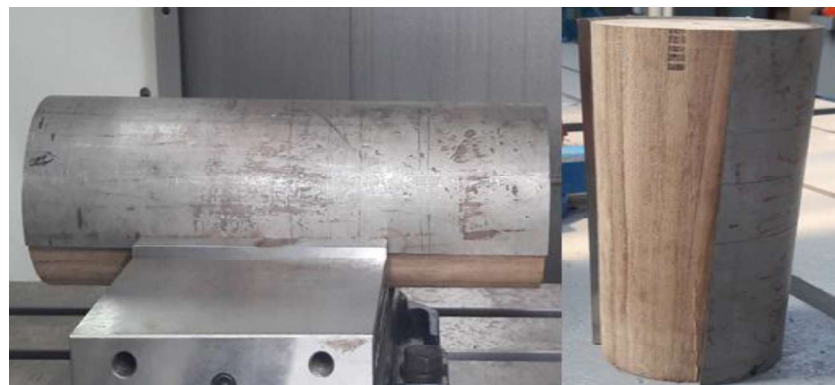
Figura 2.8. Acople de madera a tubo. (Fuente: propia)
