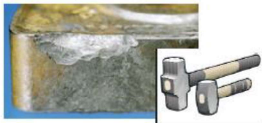
Figura 1.9. Desgaste mecánico. (Fuente: Sandvik Coromant, 2015)
