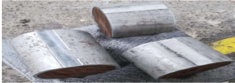
Figura 2.9. Corte en secciones del tubo para evitar vibraciones en maquinado. (Fuente: propia)
