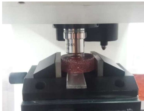
Figura 2.26. Sujeción de probeta en el microdurómetro. (Fuente: propia)
