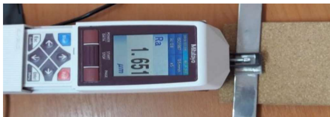
Figura 2.20. Nivelación de probeta con el palpador del rugosímetro. (Fuente: propia)
