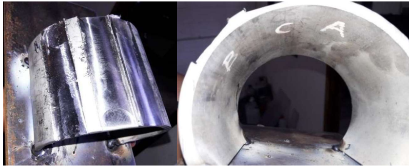
Figura 2.17. Tubería soldada a placa de acero. (Fuente: propia)
