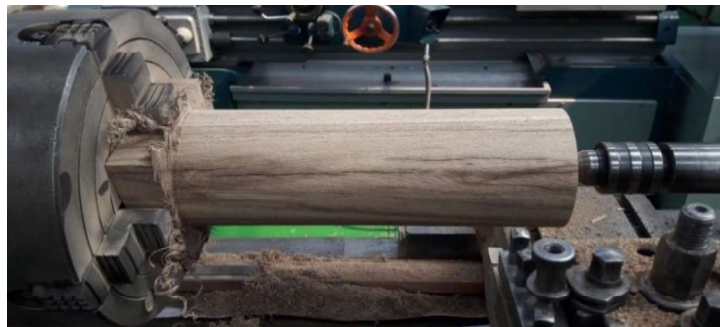
Figura 2.7. Torneado en madera para relleno de tubo. (Fuente: propia)
