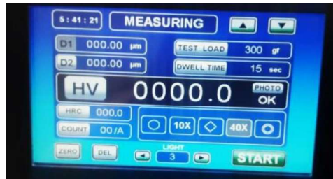
Figura 2.24. Ingreso de carga y tiempo de aplicación en el microdurómetro. (Fuente: propia)
