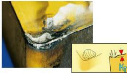
Figura 1.6. Desgaste químico. (Fuente: Sandvik Coromant, 2015)
