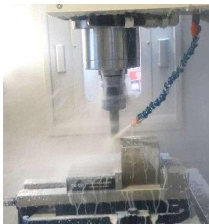
Figura 2.15. Maquinado de la pieza. (Fuente: propia)
