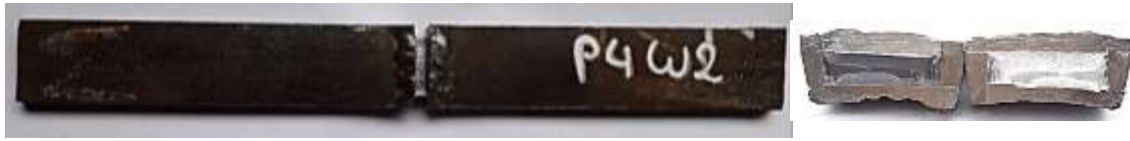
Figura 3.17 Probeta P4W2, sometida a ensayo Nick Break. (Fuente: Propia)
