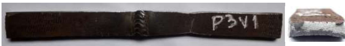
Figura 3.6 Probeta P3V1, sometida a ensayo de tracción. Fractura dúctil. (Fuente: Propia)
