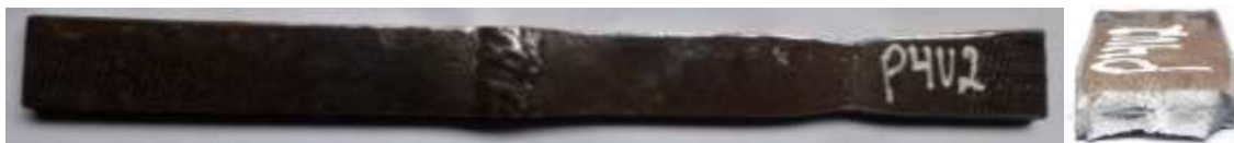
Figura 3.9 Probeta P4V2, sometida a ensayo de tracción. Fractura dúctil. (Fuente: Propia)
