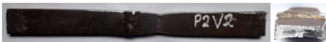
Figura 3.5 Probeta P2V2, sometida a ensayo de tracción. Fractura dúctil. (Fuente: Propia)
