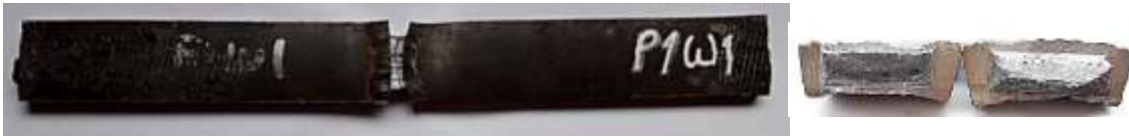
Figura 3.10 Probeta P1W1, sometida a ensayo Nick Break. (Fuente: Propia)
