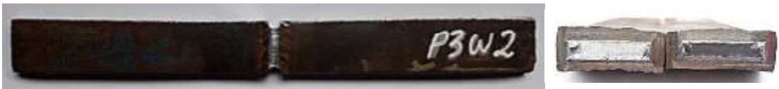
Figura 3.15 Probeta P3W2, sometida a ensayo Nick Break (Fuente: Propia)
