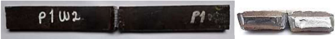
Figura 3.11 Probeta P1W2, sometida a ensayo Nick Break. (Fuente: Propia)
