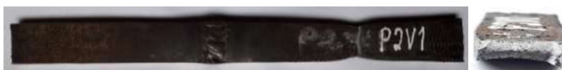
Figura 3.4 Probeta P2V1, sometida a ensayo de tracción. Fractura dúctil. (Fuente: Propia)
