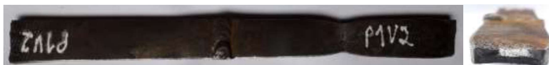
Figura 3.3 Probeta P1V2, sometida a ensayo de tracción. Fractura dúctil. (Fuente: Propia)
