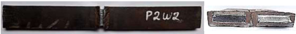
Figura 3.13 Probeta P2W2, sometida a ensayo Nick Break. (Fuente: Propia)
