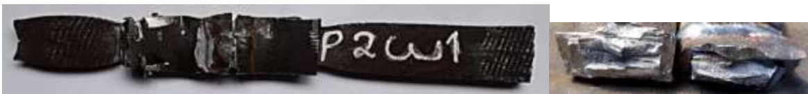
Figura 3.12 Probeta P2W1, sometida a ensayo Nick Break. (Fuente: Propia)
