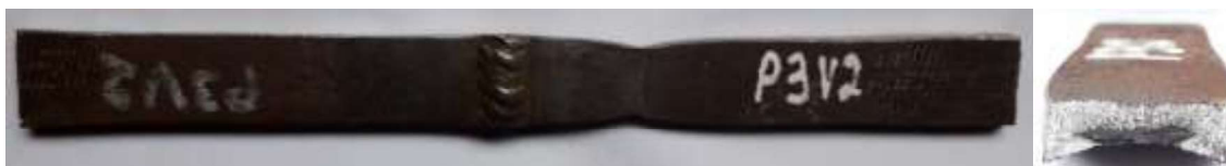
Figura 3.7 Probeta P3V2, sometida a ensayo de tracción. Fractura dúctil. (Fuente: Propia)
