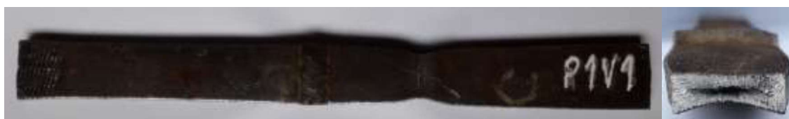
Figura 3.2 Probeta P1V1, sometida a ensayo de tracción. Fractura dúctil. (Fuente: Propia)
