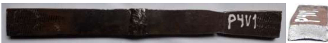
Figura 3.8 Probeta P4V1, sometida a ensayo de tracción. Fractura dúctil. (Fuente: Propia)
