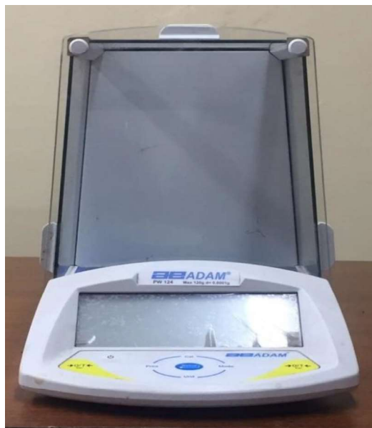
Figura 2.37. Balanza marca ADAM PW 124. (Fuente: Propia)
