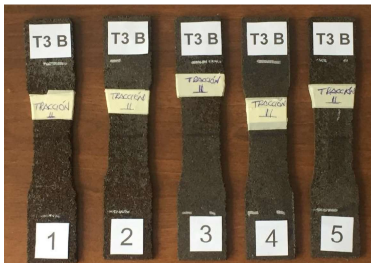
Figura 2.30. Probetas para el ensayo de tracción paralela a la superficie. (Fuente: Propia)
