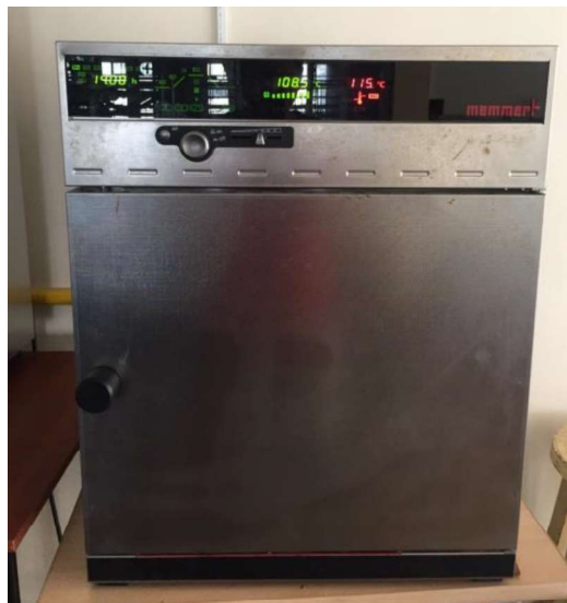
Figura 2.7. Estufa memmert UNB 500 con control de temperatura. (Fuente: Propia)
