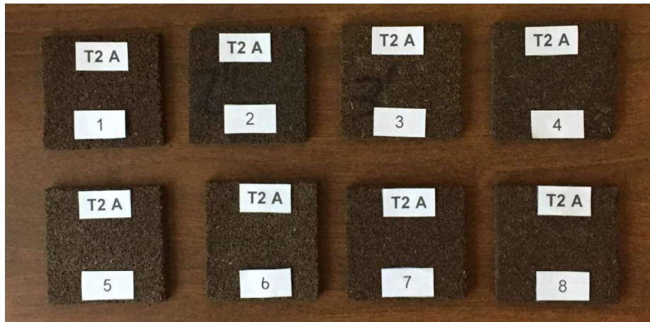
Figura 2.38. Grupo de probetas para el ensayo de contenido de humedad y densidad. (Fuente: Propia)
