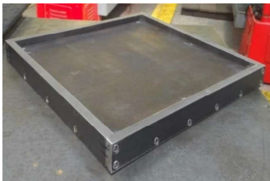
Figura 2.19. Molde metálico para la elaboración de tableros. (Fuente: Propia)
