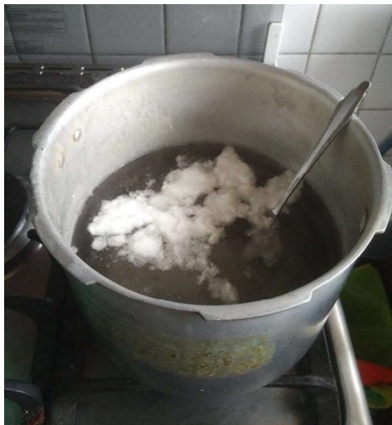
Figura 2.15. Mezcla de agua y PVA para obtener el adhesivo. (Fuente: Propia)
