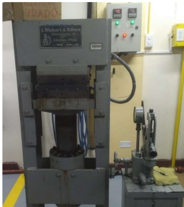
Figura 2.24. Prensado de los tableros. (Fuente: Propia)
