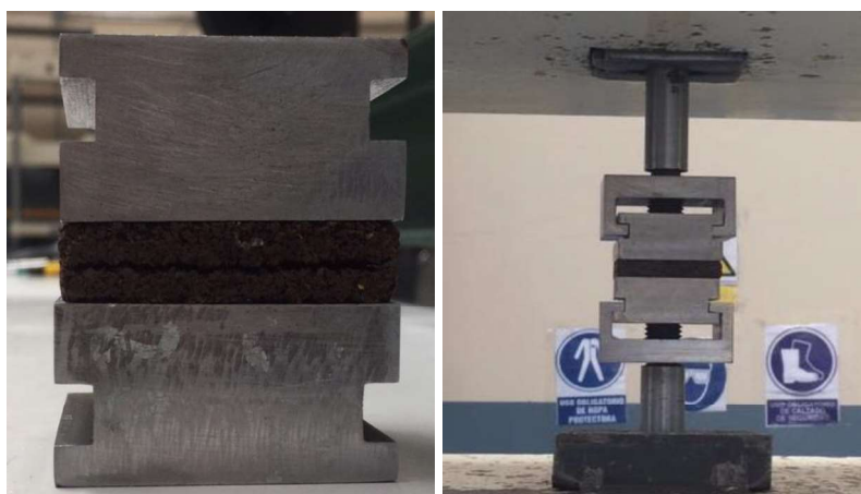
Figura 2.32. Ensayo de tracción perpendicular a la superficie. (Fuente: Propia)
