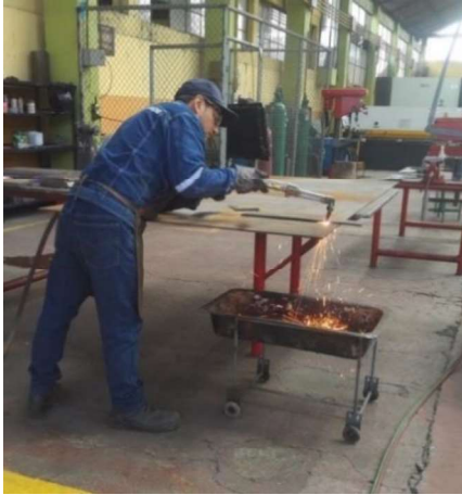
Figura 2.17. Corte oxiacetilénico de las planchas de acero. (Fuente: Propia)
