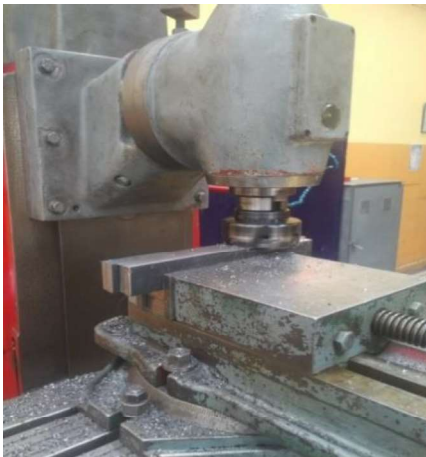
Figura 2.18. Fresado del acero para obtener las dimensiones requeridas. (Fuente: Propia)
