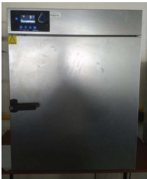
Figura 2.8. Estufa Marca POL-EKO-APARATURA SP.J. modelo SLN 115 STD con control de temperatura. (Fuente: Propia)
