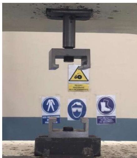
Figura 2.31. Mordazas acopladas a la maquina de ensayos universales. (Fuente: Propia)
