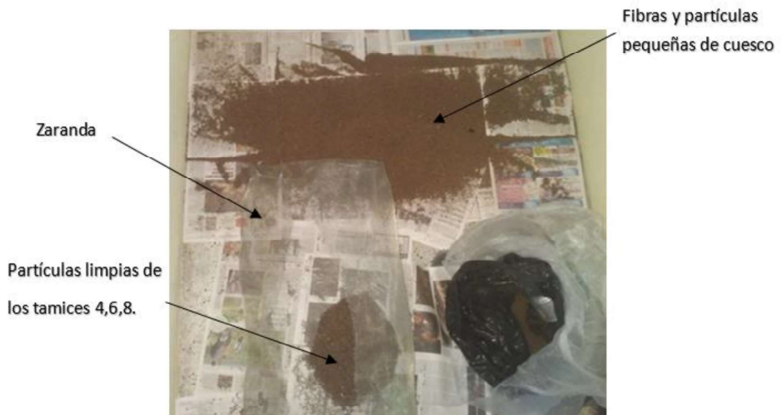
Figura 2.12. Tamizado con zaranda. (Fuente: Propia)
