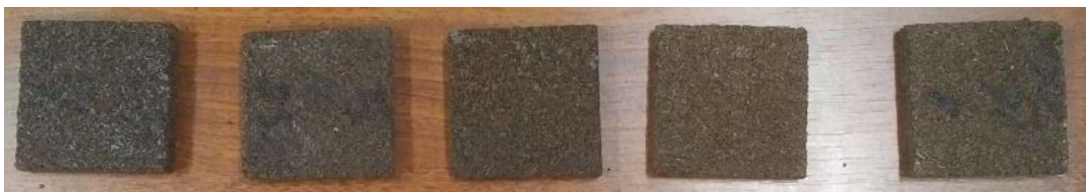
Figura 2.33. Grupo de probetas para el ensayo de tracción perpendicular a la superficie.
