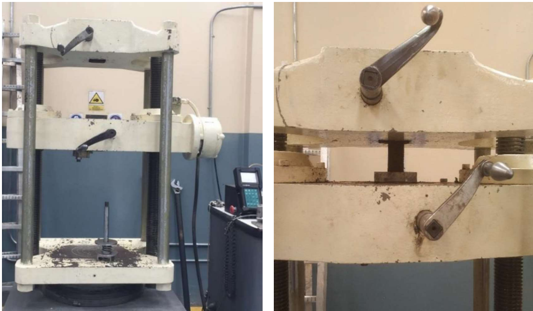
Figura 2.29. Ensayo de tracción paralela a la superficie.
