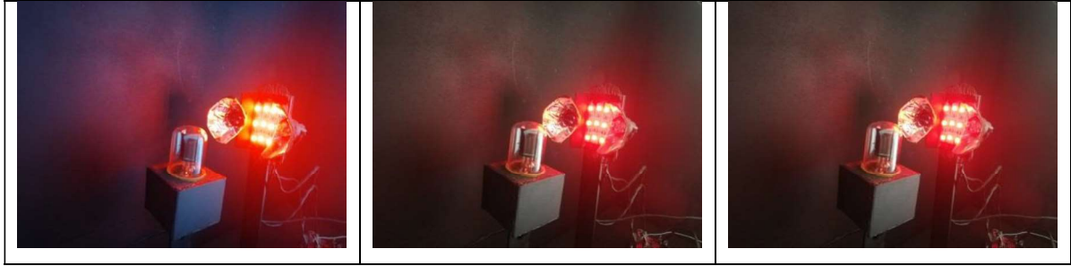
Figura 2.19 Prueba de Funcionamiento de Luz Roja, en sus tres intensidades [Fuente: Propia]
