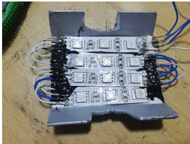
Figura 2.5 Construcción de Luminaria
