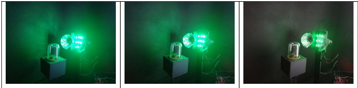
Figura 2.17 Prueba de Funcionamiento de Luz Verde, en sus tres intensidades [Fuente: Propia]
