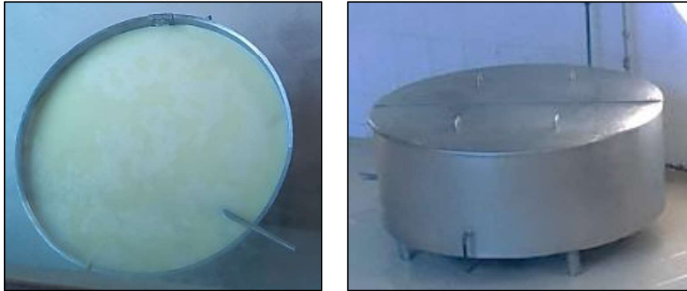
Figura 21 – Pasteurización de leche, tinas polivalentes. Elaboración Propia
