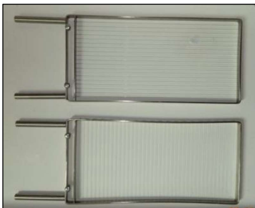
Figura 22 – Lira para corte de cuajada y batidora manual de cuajada de leche. Elaboración Propia, (Dubach, 1988, pág. 12)
