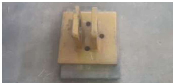
Foto 3: Placa para la transmisión de carga al muro de mampostería
