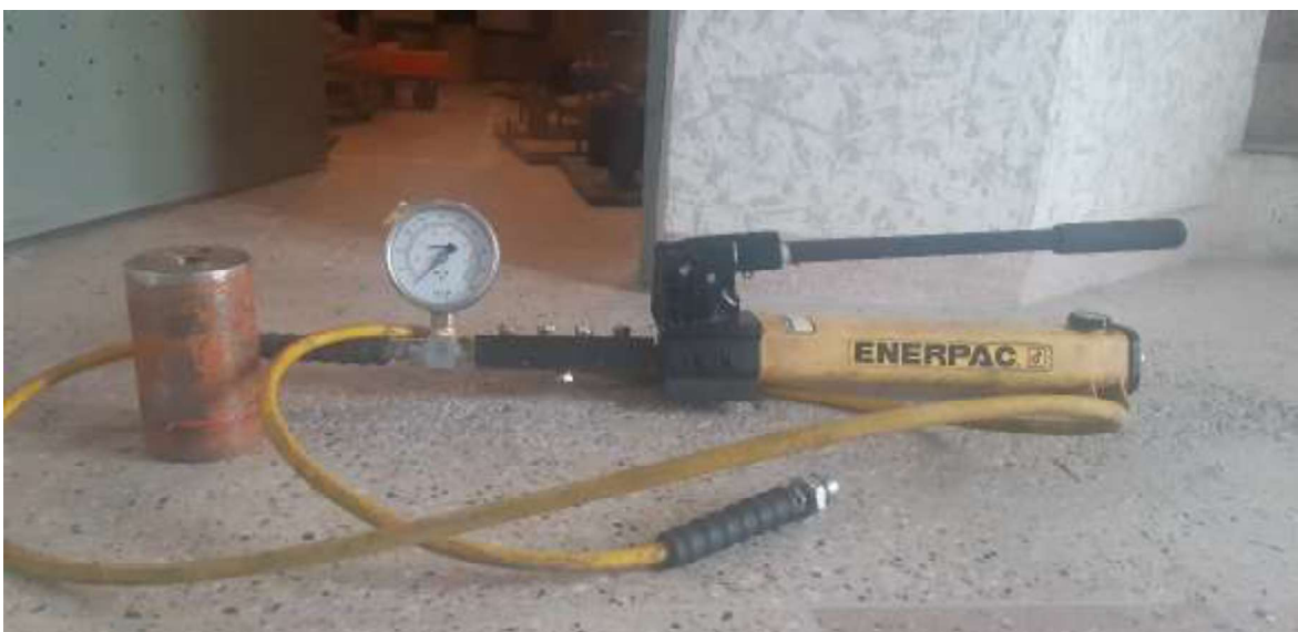
Foto 2: Gato hidráulico para el pretensado de los muros de mampostería reforzada
