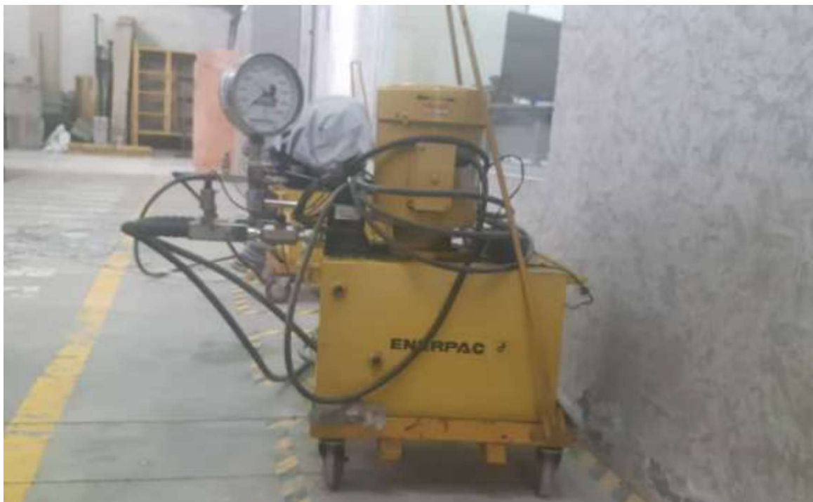
FOTO 4: Bomba eléctrica para transmitir carga (10Ton)
