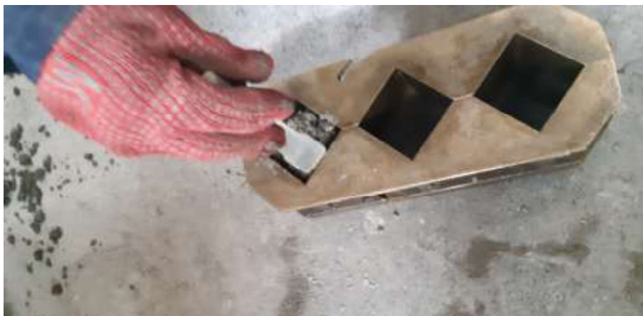
Foto 19: toma de cubos de mortero
