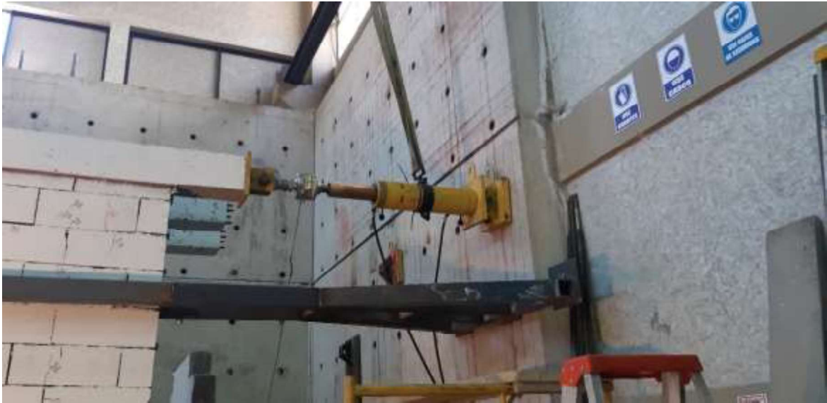
Foto 1: Gato hidráulico y guía para el muro de mampostería
