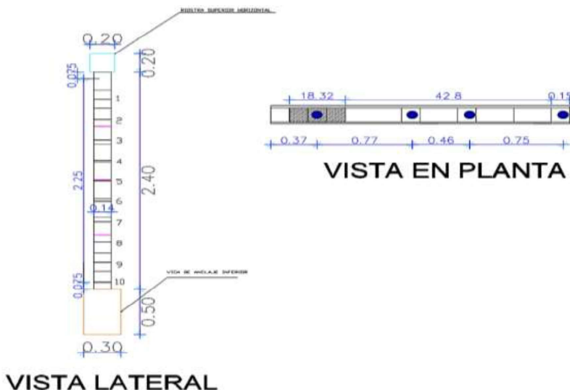
FIGURA 3.58 DISCRETIZACIÓN PARA LA SECCIÓN VERTICAL Y HORIZONTAL DEL MURO DE MAMPOSTERÍA REFORZADA
