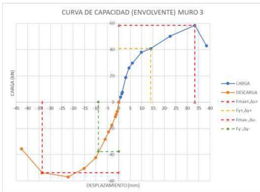
FIGURA 4.24 DUCTILIDAD DE DESPLAZAMIENTO DEL TERCER MURO DE MAMPOSTERÍA REFORZADA
