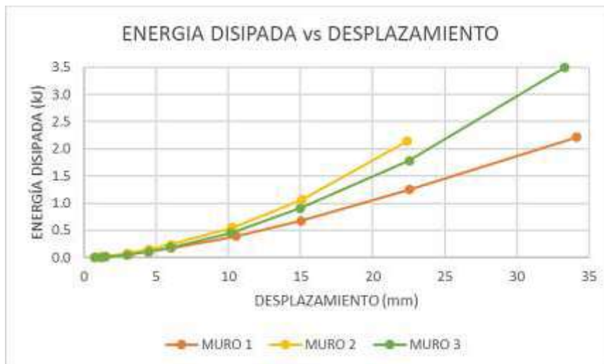
FIGURA 4.25 ENERGÍA ACUMULADA DISIPADA VS DESPLAZAMIENTO (EMPUJE) DE LOS TRES MUROS DE MAMPOSTERÍA REFORZADA
