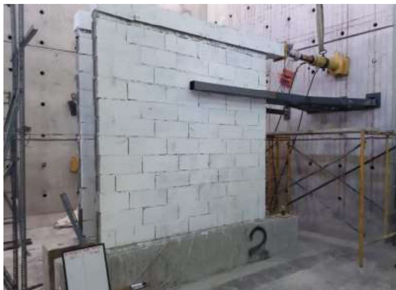
FOTOGRAFÍA 3.13 EQUIPO DE APLICACIÓN DE CARGA A CADA MURO DE MAMPOSTERIA REFORZADA
