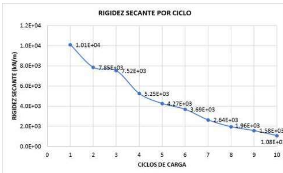
FIGURA 4.11 RIGIDEZ SECANTE POR CICLO DEL PRIMER MURO DE MAMPOSTERÍA REFORZADA
