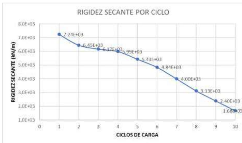
FIGURA 4.15 RIGIDEZ SECANTE POR CICLO DEL TERCER MURO DE MAMPOSTERÍA REFORZADA
