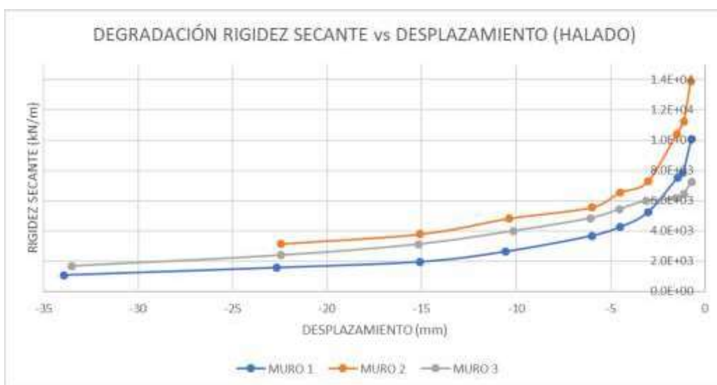
FIGURA 4.28 DEGRADACIÓN DE RIGIDEZ VS DESPLAZAMIENTO (HALADO) DE LOS TRES MUROS DE MAMPOSTERÍA REFORZADA
