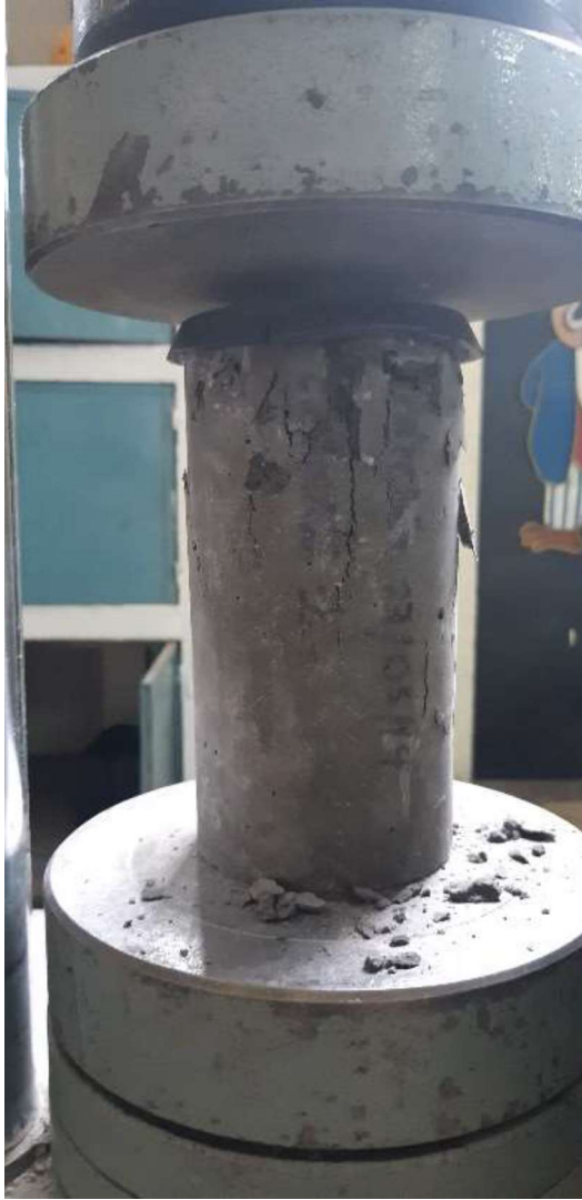
Foto 18: Ensayo de cilindros de hormigón y grout
