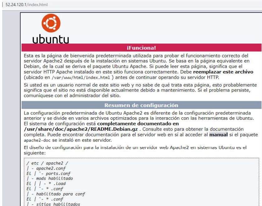
Figura 2.56 Verificación de instalación de Apache.
