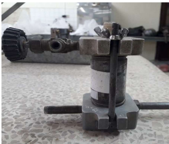
FIGURA 3. 14. ENSAYO DE PERMEABILIDAD DE LAS MUESTRAS M3, M4 Y M5.
