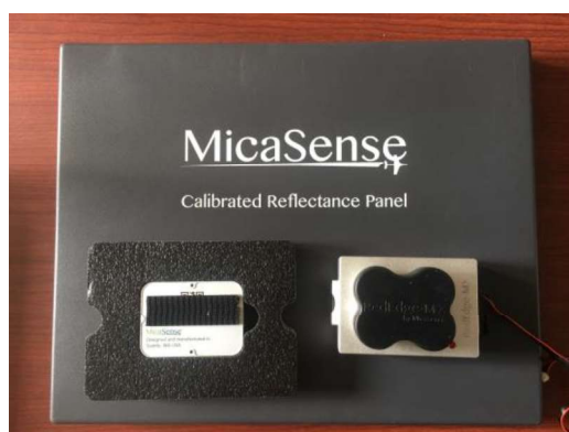
Figura 2. Panel de calibración, Receptor GPS y Cámara multiespectral
