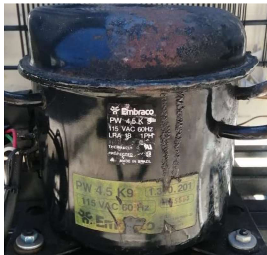
Figura 3.13. Compresor reciclado Embraco de 1/8 [HP]. Fuente propia.
