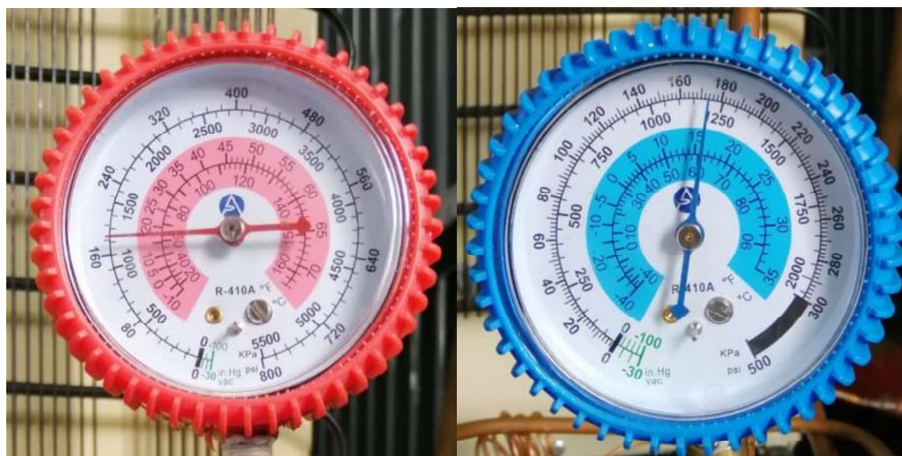
Figura 3.34. Presión de alta y baja iguales en la presurización de nitrógeno. Fuente propia.
