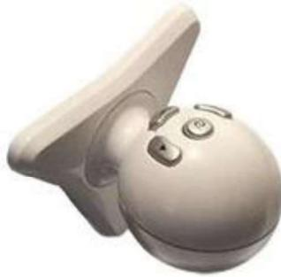
**Figura 2.2.** Efector final del dispositivo Novint Falcon [35]
