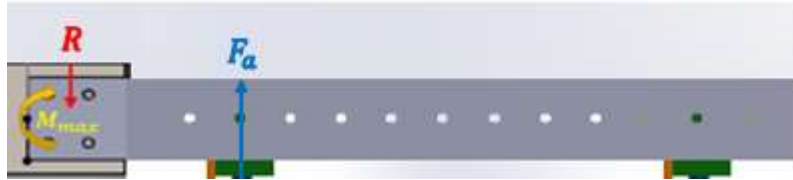
Figura 2.19. Diagrama de fuerzas placa de sujeción (rotado 270°). (Fuente: Propia)
