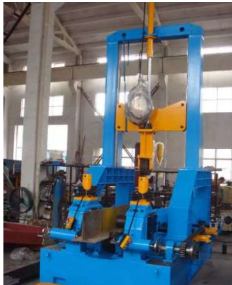
Figura 1.6. Ensamble de vigas IPE en posición vertical. (Fuente:[12])
