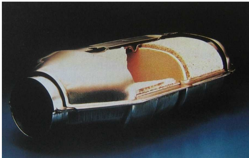
Figura N°2.3-2 Ejemplo de monolito de sección compuesta 4
