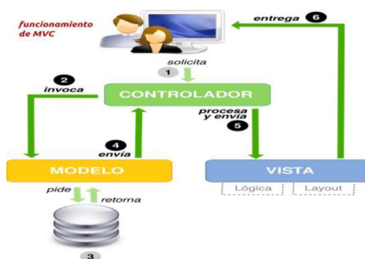
Figura 12 Arquitectura Modelo Vista Controlador
