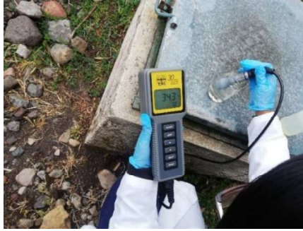
Figura 31 Medición de conductividad y temperatura Fuente: El autor, 2019
