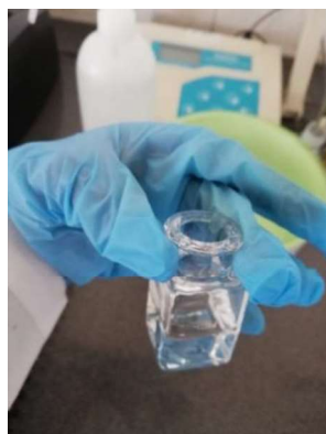
Figura 37 Medición de color con uso de espectrofotómetro
