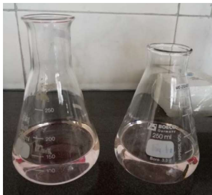
Figura 38 Titulación para análisis de alcalinidad Fuente: El autor, 2019
