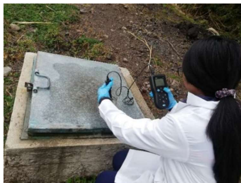
Figura 28 Medición de pH-análisis in situ Fuente: El autor, 2019
