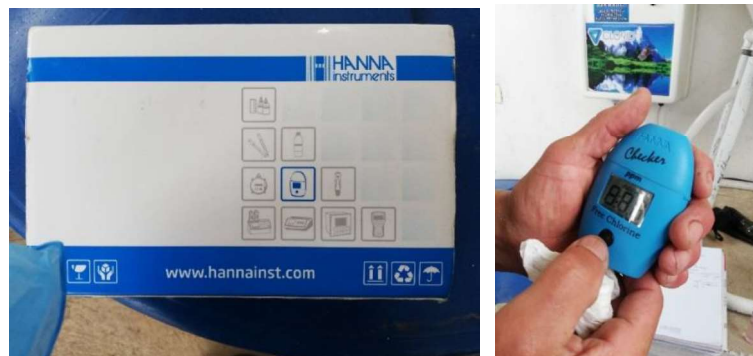
Figura 32 Medidor de cloro libre residual Fuente: El autor, 2019
