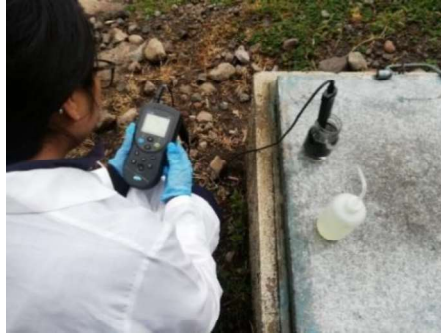
Figura 29 Medición de oxígeno disuelto Fuente: El autor, 2019
