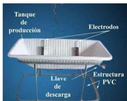
Figura 10 Sistema Clorid Fuente: Manual Sistema Clorid L-30
