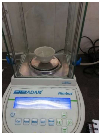
Figura 36 Tarado de los crisoles Fuente: El autor, 2019
