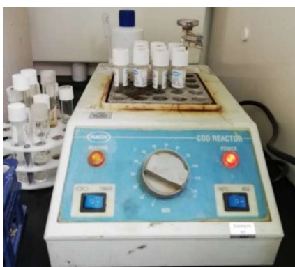
Figura 40 Digestión de viales para análisis de DQO Fuente: El autor, 2019
