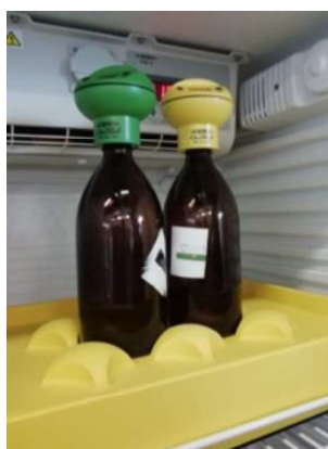
Figura 41 Determinación de DBO 5 Fuente: El autor, 2019
