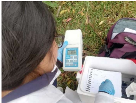
Figura 30 Medición de turbidez Fuente: El autor, 2019
