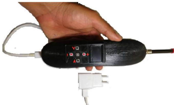
Figura A.8. Conexión del cargador del equipo.
