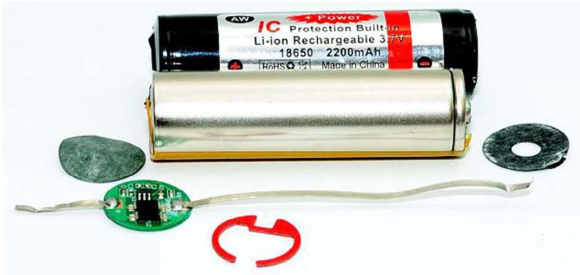
Figura 2.15. Componentes que protegen la batería de Li-Ion 18650 [49].
