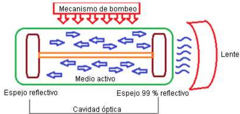
Figura 1.7. Partes físicas del láser [12].
