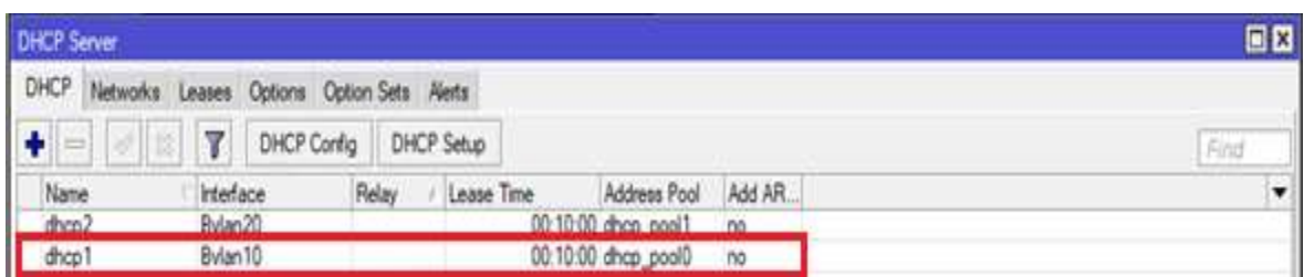
Figura 3.23 Configuración de Servidor DHCP para la Bvlan10 .
