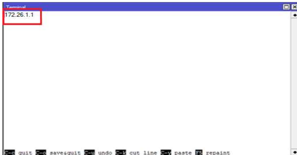
Figura 3.18 Asignación de dirección IP de Loopback al ID OSPF .
