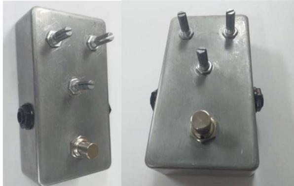
**Figura 2.59.** Placa de Distorsión acoplada en su caja
