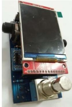
**Figura 2.55.** Placa de Afinador con pantalla colocada
