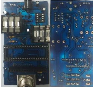
**Figura 2.53.** Parte frontal y reverso de la placa de Afinador
