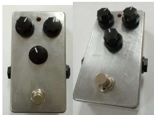
**Figura 2.60.** Placa de Delay acoplada en su caja
