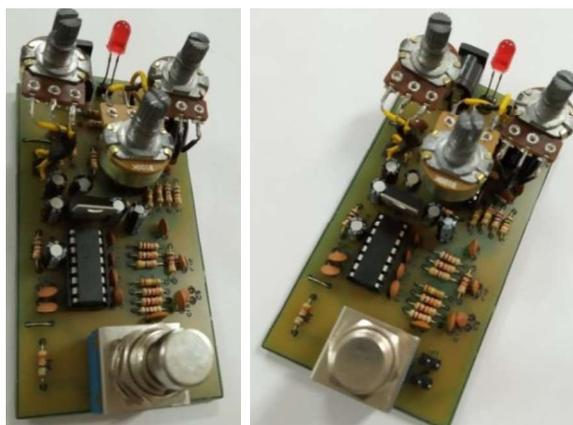
**Figura 2.52.** Placa terminada de Delay
