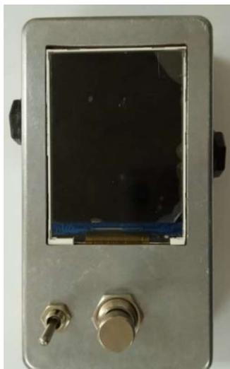
**Figura 2.61.** Placa de Afinador acoplada en su caja
