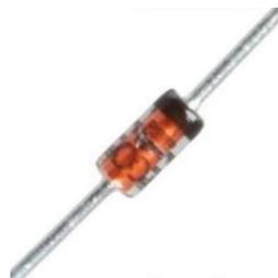
**Figura 2.15.** Diodo rápido de señal pequeña 1N914
