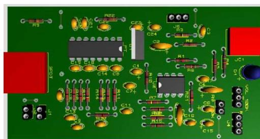
**Figura 2.37.** Distribución de componentes de la placa de delay
