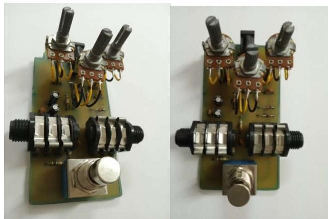
**Figura 2.50.** Placa terminada de Distorsión
