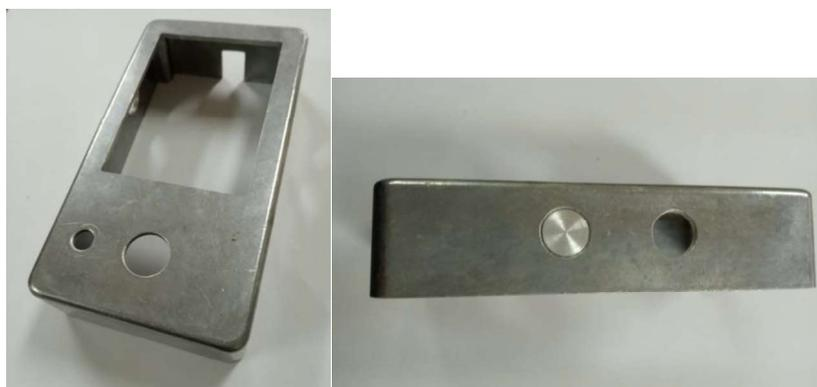
**Figura 2.58.** Caja de aluminio perforada para pedal de afinación
