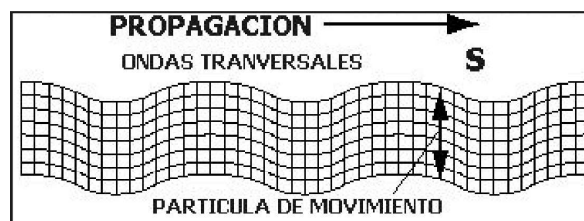
Figura 4.7: El movimiento de la partícula es perpendicular a la dirección de propagación de la onda S. Tomado de Caturla y Palacios (2001).
