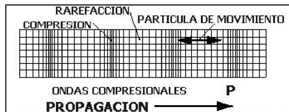
Figura 4.6: La onda P al propagarse dilata y comprime el material por el cual atraviesa. Tomado de Caturla y Palacios (2001).
