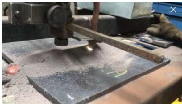
Figura 2.14. Soldadura de probeta P3.
