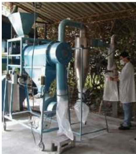
Foto N°4: Planta piloto modular para la producción de harina de malanga
