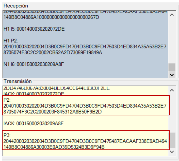
Figura 3.24. Transmisión de las tramas P2 y P3 desde el Equipo A.
