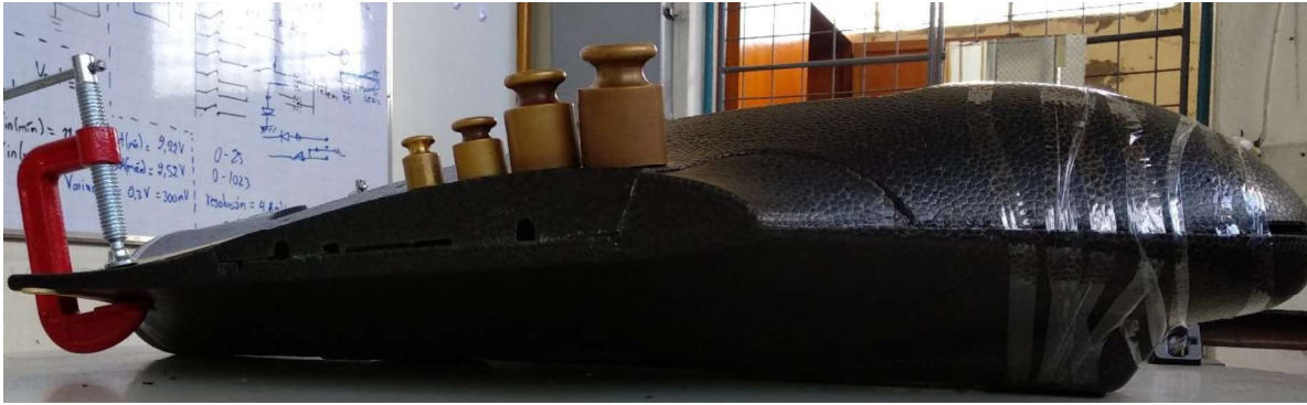
Figura 27. Proceso de curado del pegamento
