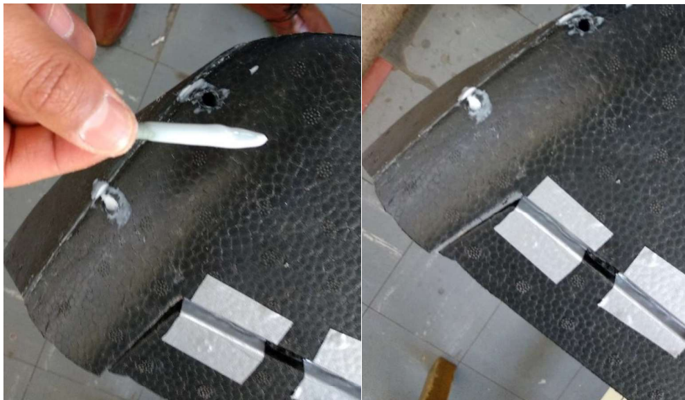
Figura 25. Fijación del dispositivo de punta alar
