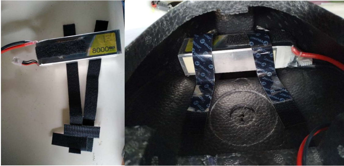
Figura 29. (a) Batería y velcro adhesivo. (b) Fijación de la batería con velcro.
