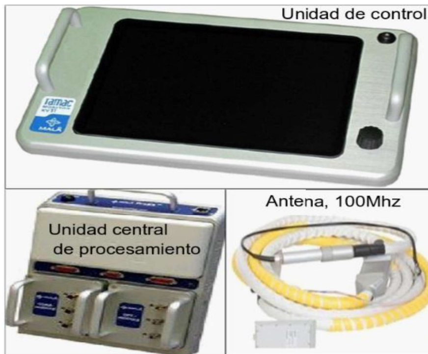
Figura 3-55. Ground Penetrating Radar compuesto por: unidad de control, unidad central de procesamiento y una antena de 100 Mhz.
