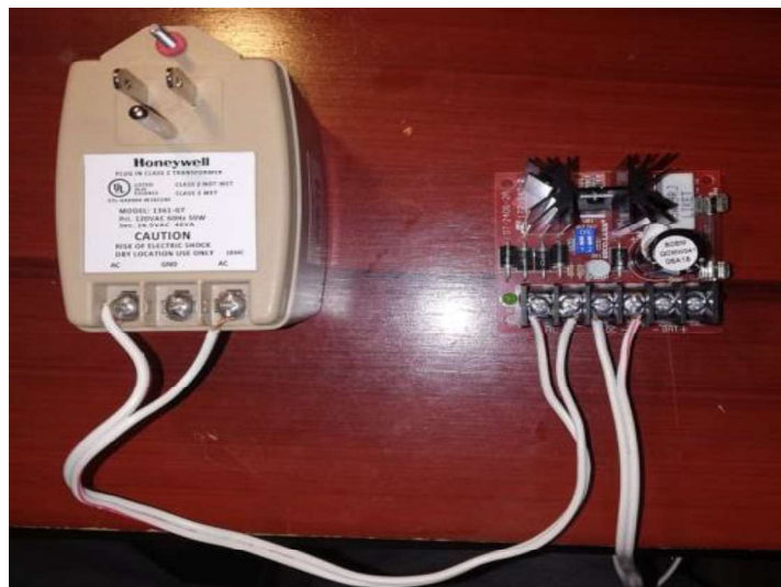
Figura 2.56. Conexión transformador - fuente de la cerradura
