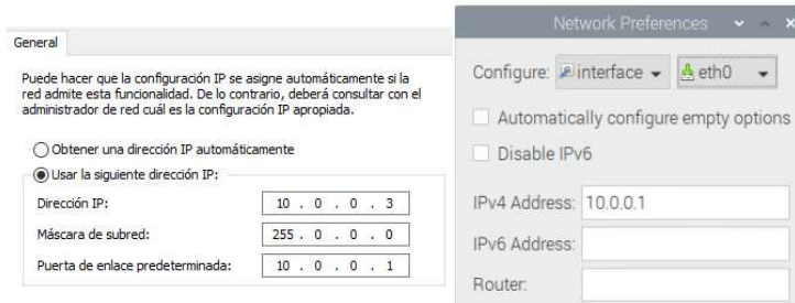
Figura 2.59. Configuración de IPs - PC y Raspberry
