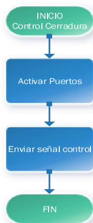
Figura 2.9. Diagrama de flujo - Función control de cerradura
