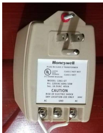
Figura 2.20. Transformador 120V AC – 16.5V AC
