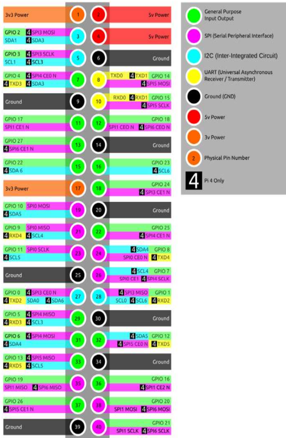
Figura 2.39. Puertos GPIO - Raspberry Pi 4 modelo B [39]
