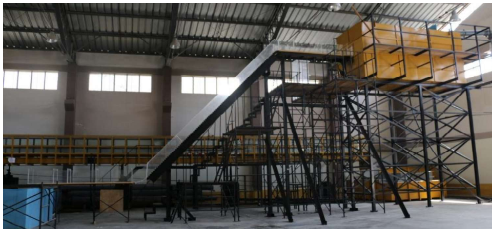
Fotografía No. 3.1: Instalación experimental de la rápida con perfil escalonado en el laboratorio del CIERHI.
