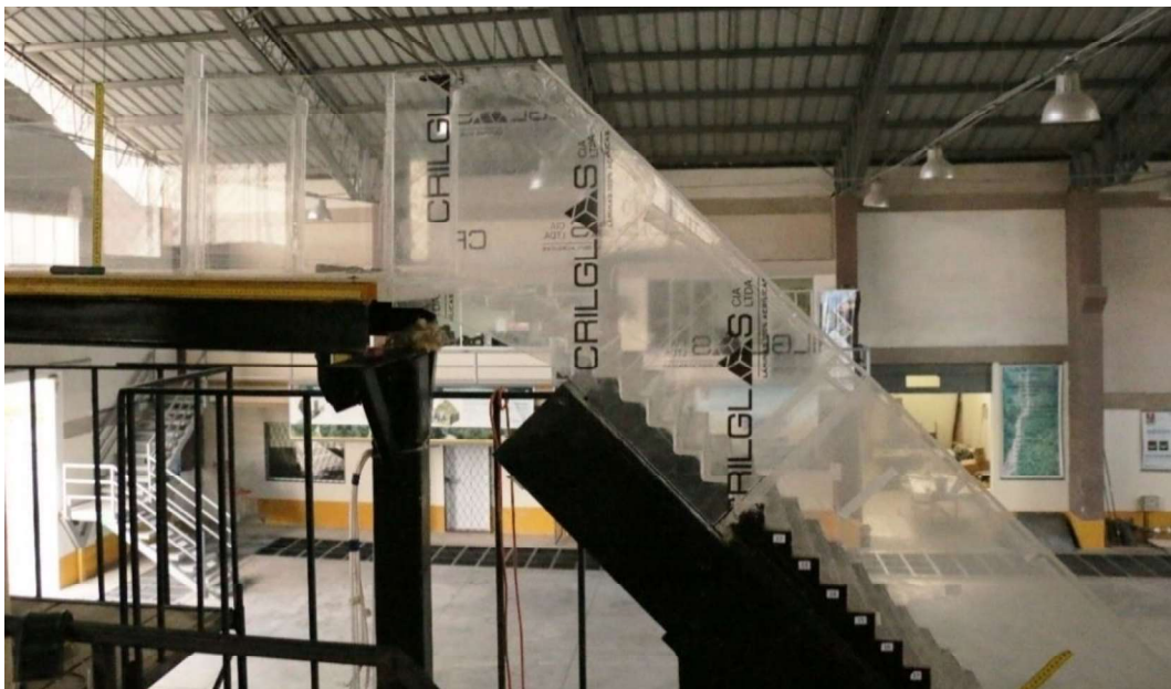
Fotografía No. 4.17: Vista lateral de la Instalación experimental con el perfil curvo escalonado instalado.
