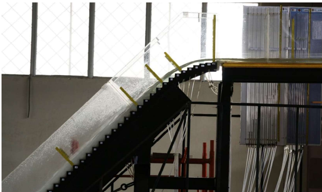
Fotografía No. 95: Prueba 2, Geometría con diseño Modificado M2. Vista lateral derecha del flujo en la rápida escalonada.
