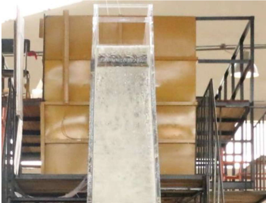
Fotografía No. 4.11: Prueba 0, Geometría con diseño Modificado M1. Vista lateral derecha del flujo en el inicio del canal de salida.
