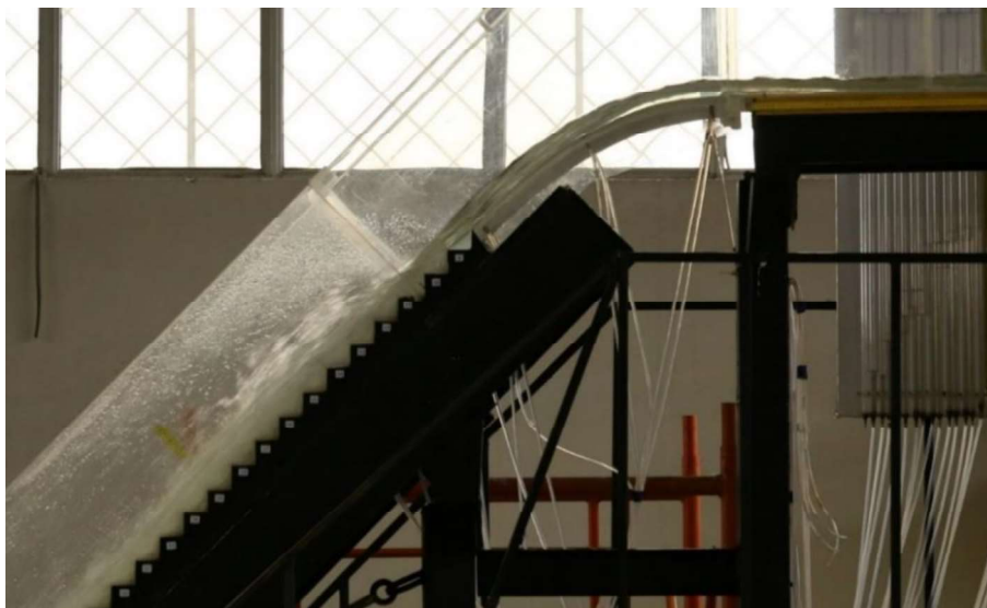
Fotografía No. 62: Prueba 2, Geometría con diseño Modificado M1. Vista lateral izquierda del flujo en el inicio de la rápida escalonada.
