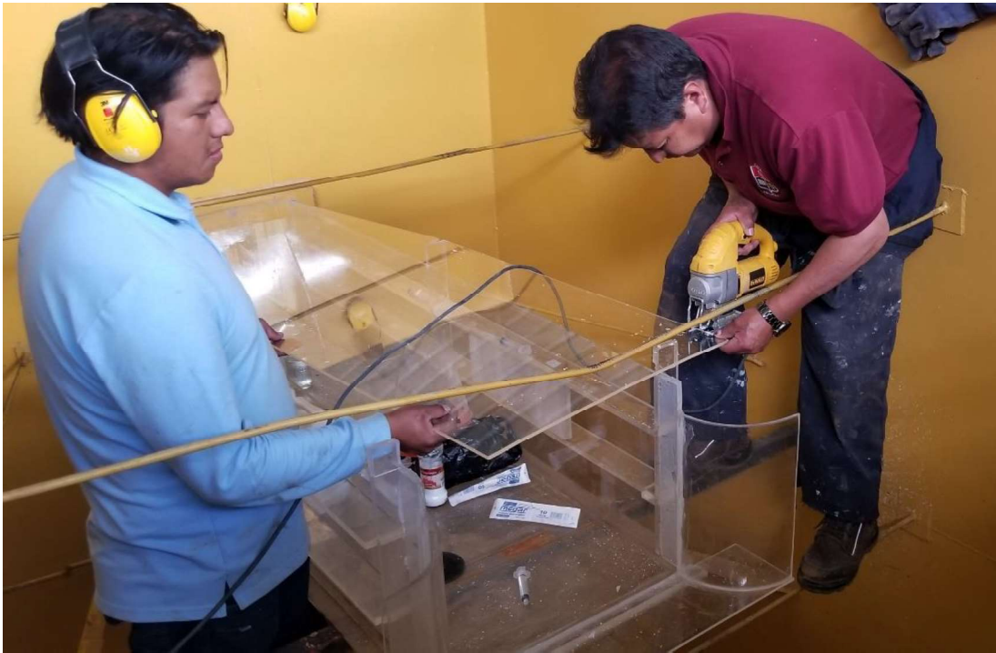
Fotografía No. 3: Colocación del canal de ingreso con pendiente fija del 2% dentro del tanque de abastecimiento, para tener flujo de aproximación supercrítico.
