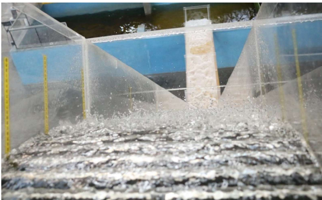
Fotografía No. 4.22: Prueba 0, Geometría con diseño Modificado M2. Vista superior del flujo en el inicio de la rápida escalonada.
