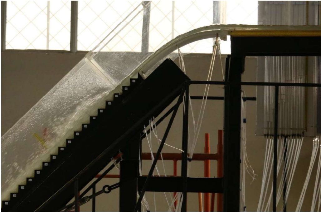
Fotografía No. 58: Prueba 1, Geometría con diseño Modificado M1. Vista lateral izquierda del flujo en la rápida escalonada.
