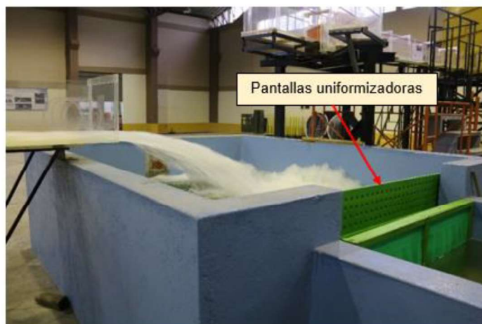
Fotografía No. 3.13: Tanque de aforo y pantallas de uniformización del flujo.
