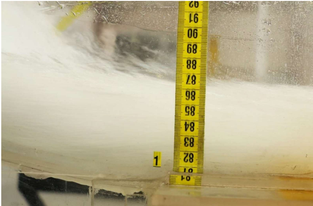
Fotografía No. 119: Prueba 5, Geometría con diseño Modificado M2. Vista lateral derecha del flujo en el inicio del canal de salida.
