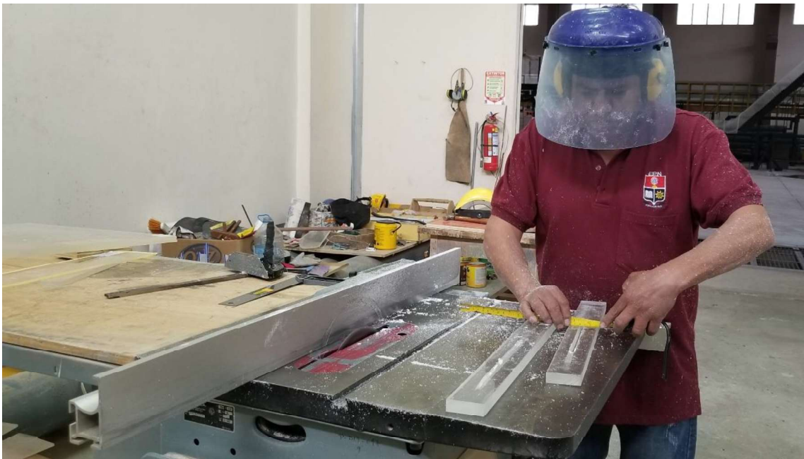
Fotografía No. 6: Elaboración de las piezas en acrílico de la compuerta a ser ubicada en el canal de ingreso dentro del tanque de abastecimiento.
