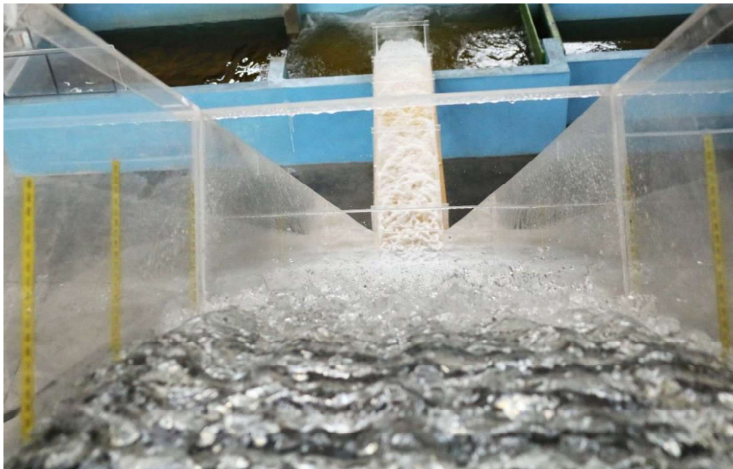
Fotografía No. 97: Prueba 2, Geometría con diseño Modificado M2. Vista superior del flujo en el inicio de la rápida escalonada.
