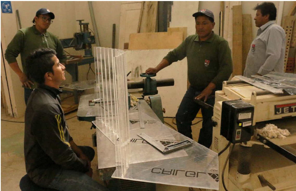
Fotografía No. 29: Pieza del perfil curvo escalonado para la geometría modificada M2 ensamblada.
