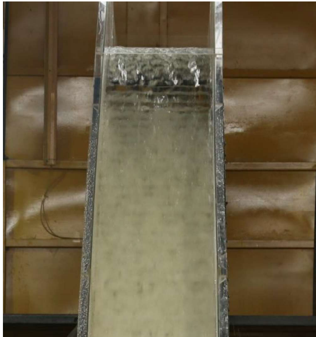
Fotografía No. 63: Prueba 2, Geometría con diseño Modificado M1. Vista frontal del flujo en el inicio de la rápida escalonada.
