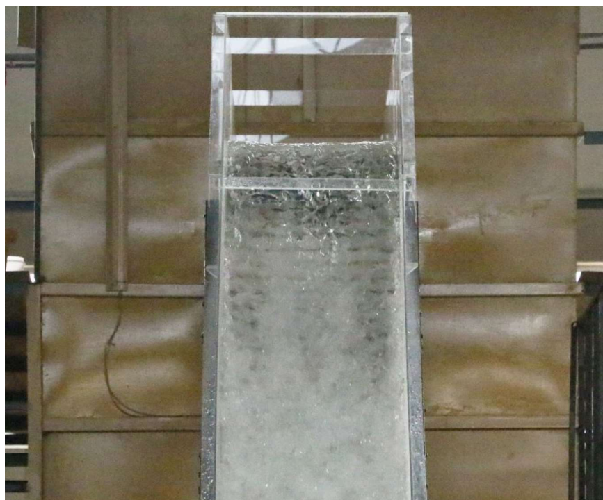
Fotografía No. 110: Prueba 4, Vista frontal del flujo en el inicio de la rápida escalonada.
