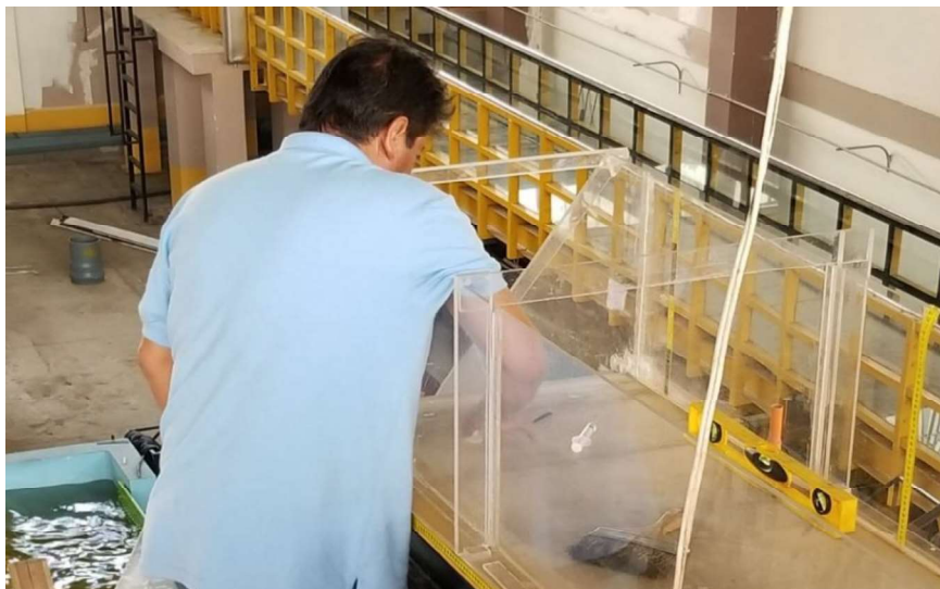
Fotografía No. 3.7: Empate del canal de aproximación con la rápida escalonada.
