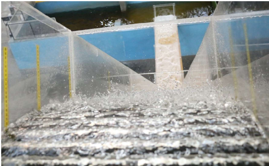
Fotografía No. 83: Prueba 0, Geometría con diseño Modificado M2. Vista superior del flujo en el inicio de la rápida escalonada.
