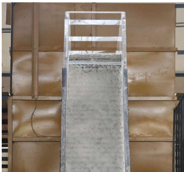
Fotografía No. 82: Prueba 0, Geometría con diseño Modificado M2. Vista frontal del flujo en el inicio de la rápida escalonada.
