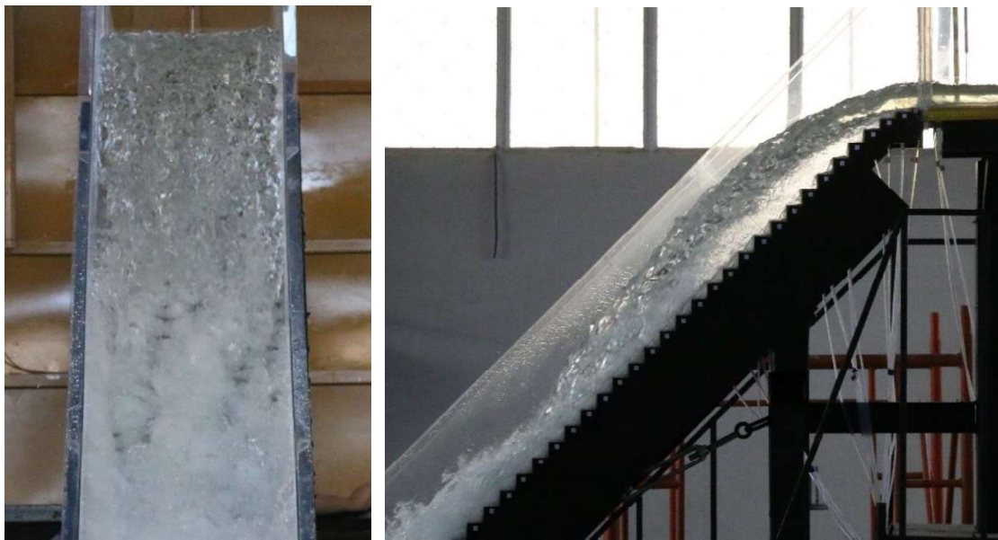
Fotografía No. 52: Prueba 5. Geometría con diseño Original, (A) Vista frontal del flujo y (B) Vista lateral izquierda del flujo en la rápida escalonada.
