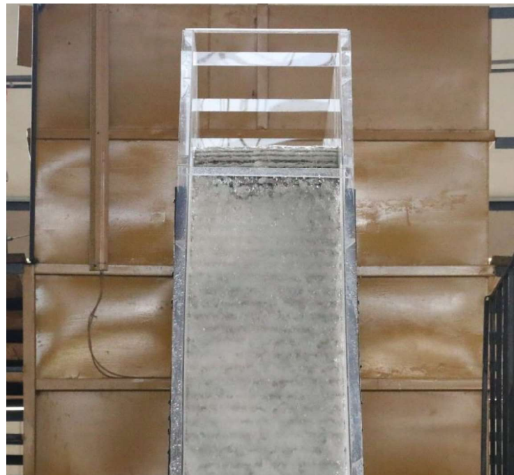
Fotografía No. 4.21: Prueba 0, Geometría con diseño Modificado M2. Vista frontal del flujo en el inicio de la rápida escalonada.
