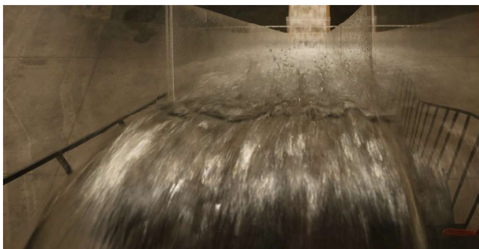
Fotografía No. 67: Prueba 3, Geometría con diseño Modificado M1. Vista superior del flujo en el inicio de la rápida escalonada.
