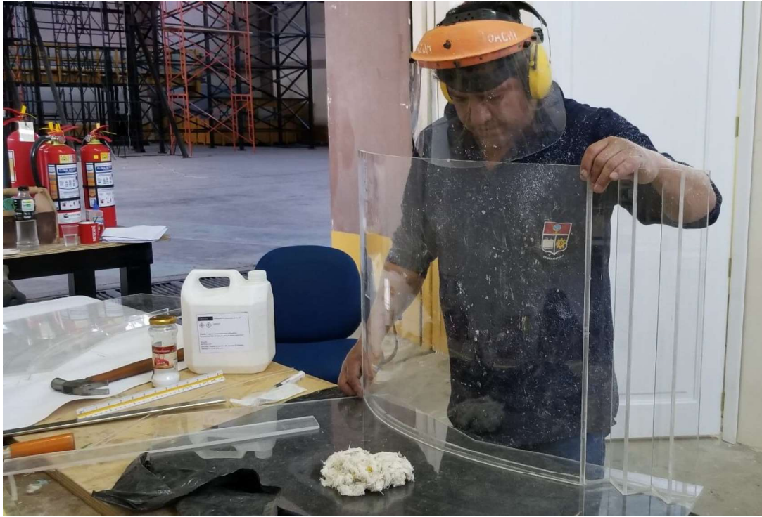
Fotografía No. 19: Ensamblaje de la pieza completa M1, con perfil liso curvo.
