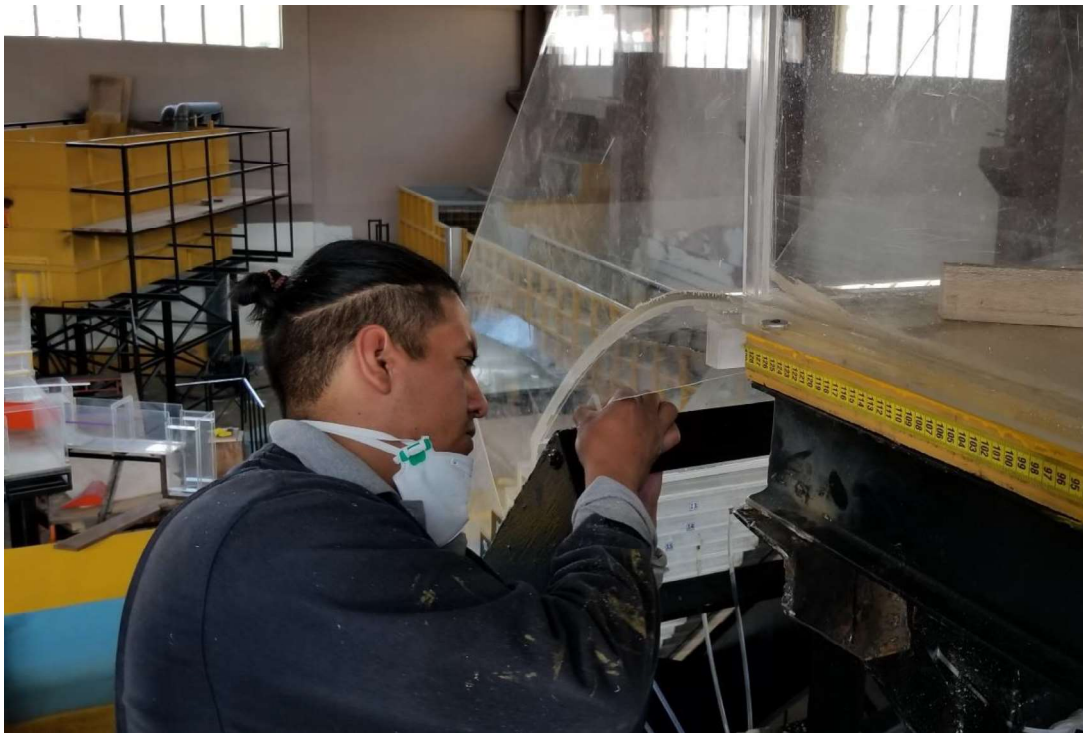
Fotografía No. 20: Implantación de la pieza completa M1 en la rápida escalonada.
