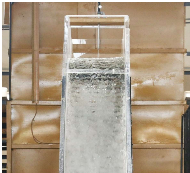
Fotografía No. 103: Prueba 3. Vista frontal del flujo en el inicio de la rápida escalonada.
