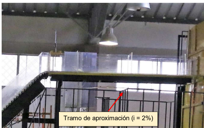
Fotografía No. 3.8: Perspectiva del canal de aproximación en la instalación de la rápida escalonada para un flujo supercrítico con geometría original.
