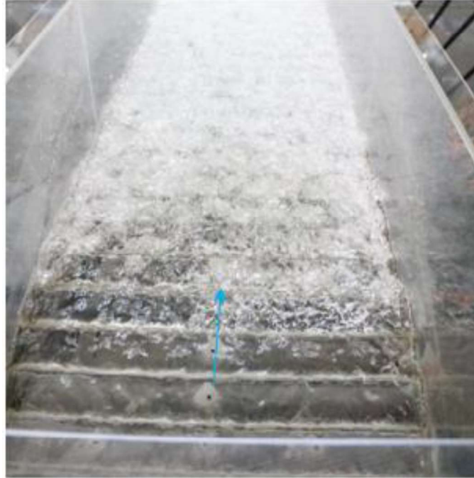
Fotografía No. 4.3: Prueba 0. Vista lateral derecha, flujo al pie de la rápida e inicio del canal de salida.
