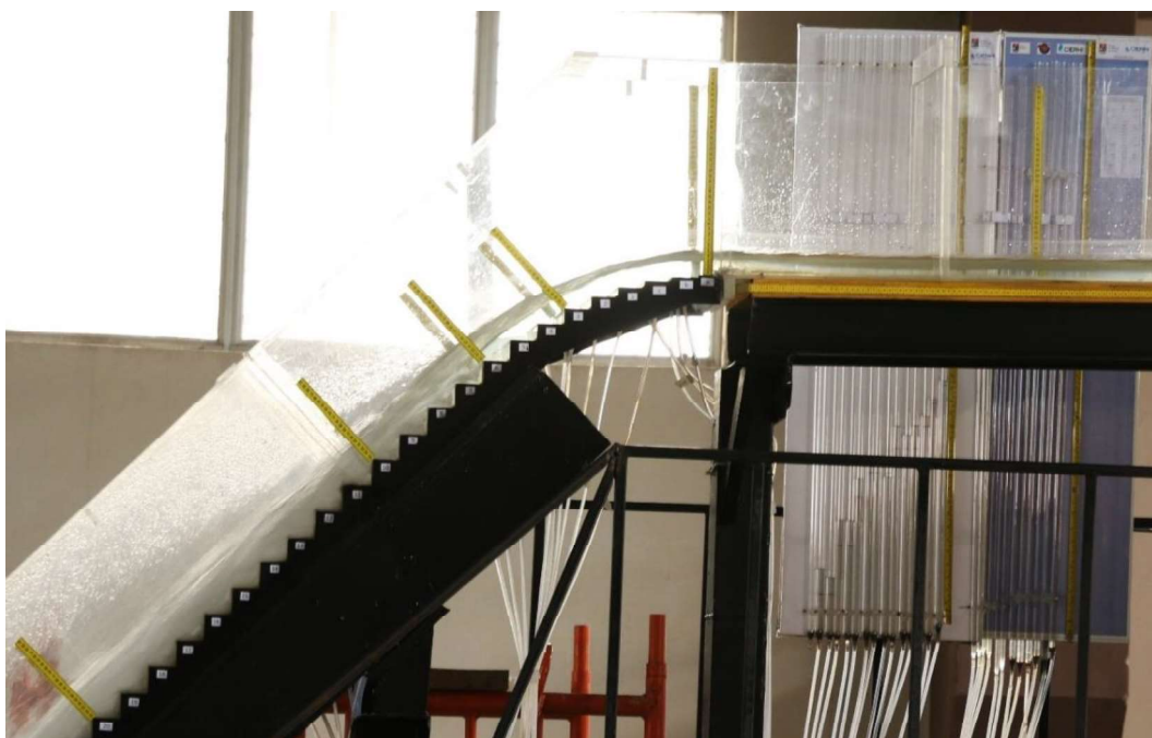
Fotografía No. 102: Prueba 3, Geometría con diseño Modificado M2. Vista lateral derecha del flujo en la rápida escalonada.
