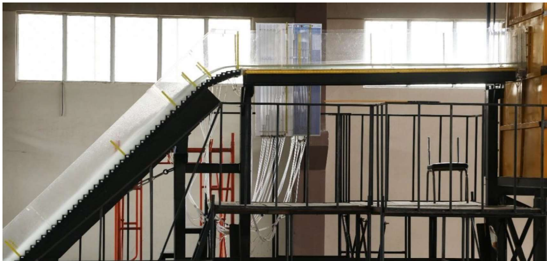
Fotografía No. 109: Prueba 4, Geometría con diseño Modificado M2. Vista lateral derecha del flujo en la rápida escalonada.
