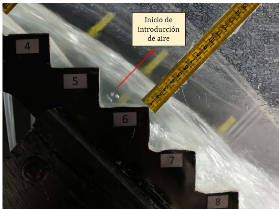
Fotografía No. 87: Prueba 1, Geometría con diseño Modificado M2. Vista lateral derecha del flujo en el punto de inicio de introducción de aire en la rápida escalonada.
