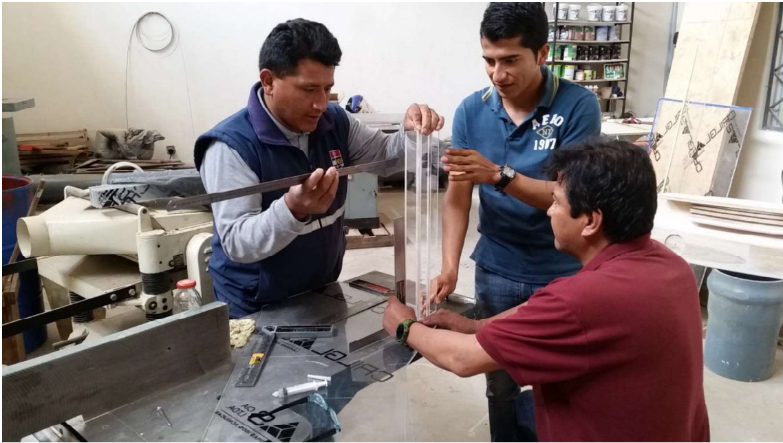
Fotografía No. 28: Ensamblaje de la pieza del perfil curvo escalonado para la geometría modificada M2.
