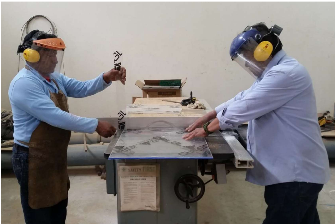
Fotografía No. 27: Fabricación de los escalones de la pieza del perfil curvo escalonado para la geometría modificada M2.
