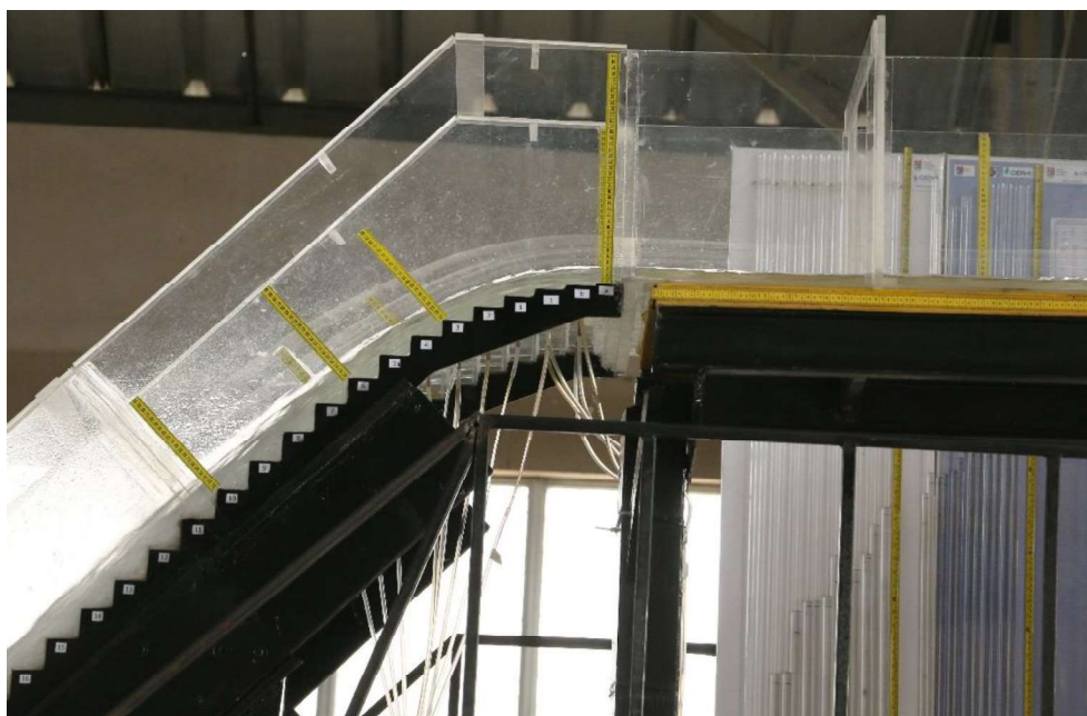
Fotografía No. 88: Prueba 1, Geometría con diseño Modificado M2. Vista lateral derecha del flujo en la rápida escalonada.
