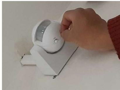
Figura 3.14: Configuración de sensor de movimiento.
