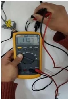
Figura 3.28: Comprobación de voltaje de cámaras.
