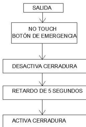
Figura H.10: Diagrama de flujo de la salida del Laboratorio.
