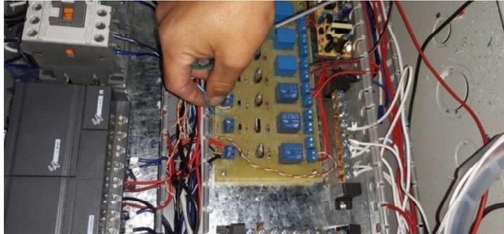
Figura 3.9: Conexión del lector a placa.
