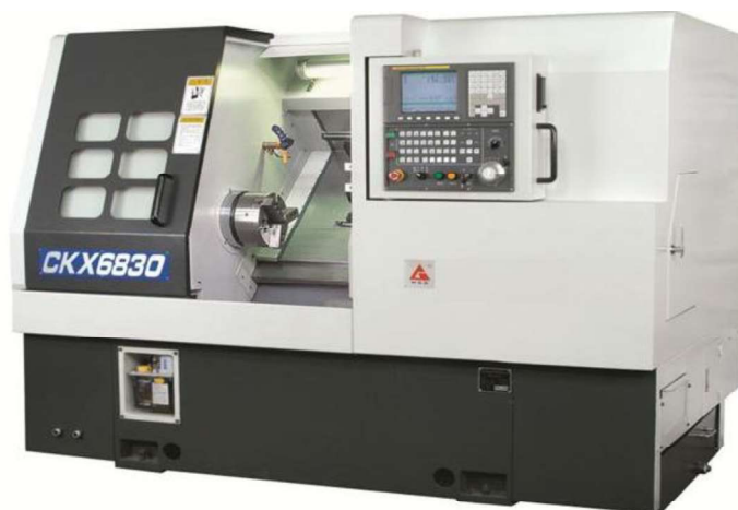
Figura 1.20. Torno de bancada inclinada CK 45 (CKX 6830). (Fuente: La Casa del Tornero, 2019)
