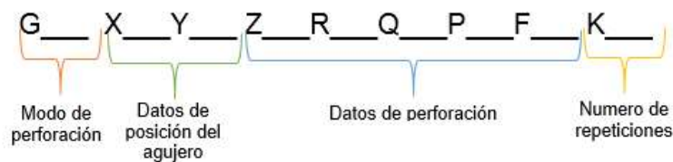
Figura 2.18. Sintaxis del código G de los ciclos de perforación y roscado. (Fuente: Propia)
