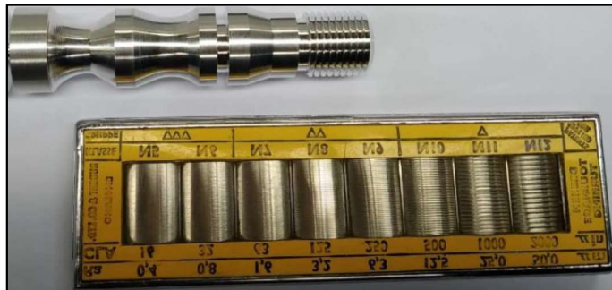
Figura 3.84. Comprobación del acabado de la Pieza 1. (Fuente: Propia)
