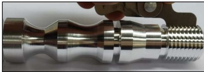
Figura 3.83. Comprobación de paso de rosca (PIEZA 1). (Fuente: Propia.)
