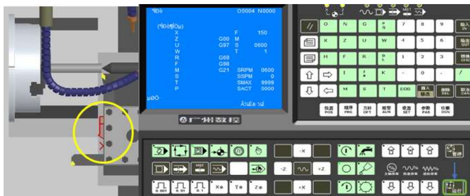
Figura 3.31. Fijación de sistema de coordenada cero pieza. (Fuente: Propia)
