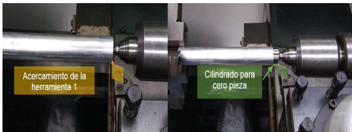
Figura 3.46. Primeros pasos para realizar el cero pieza (torneado exterior). (Fuente: Propia)
