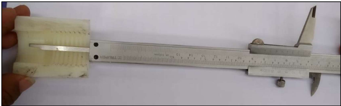
Figura 3.91. Medición de la longitud (Pieza 3) . (Fuente: Propia)
