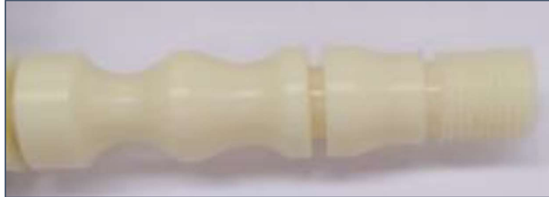
Figura 3.85. Pieza 1 mecanizada en grilón. (Fuente: Propia)
