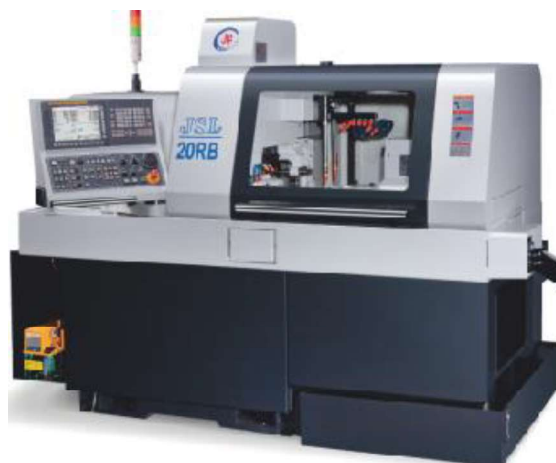
Figura 1.21. Torno CNC Jinn Fa (cabezal móvil). (Fuente: IMOCOM S.A.S, 2018)
