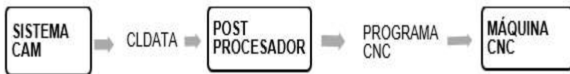
Figura 1.33. Post-procesamiento en la Integración CAD/CAM.
