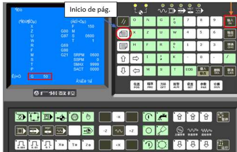
Figura 3.29. Activación de coordenada de cero pieza . (Fuente: Propia)
