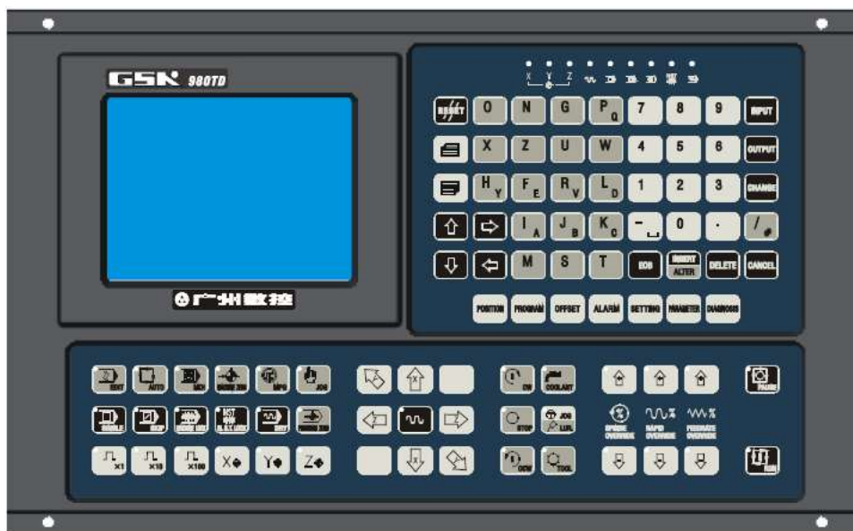
Figura 1.25. Panel de control del controlador GSK980TD. (Fuente: GSK CNC EQUIPMENT CO., LTD., s. f.)
