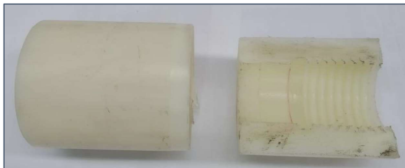
Figura 3.92. Pieza 3 con Operaciones Internas en grilón. (Fuente: Propia)
