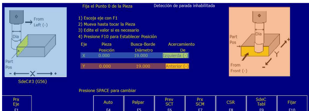
Figura 3.77. Definición del cero pieza en el eje X y el eje Y. (Fuente: Propia)
