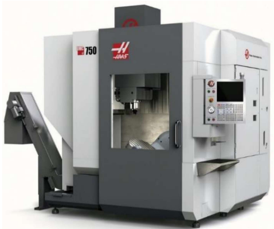
Figura 1.28. Centro de mecanizado universal HAAS UMC750 (Fuente: METALMECANICA, 2019)
