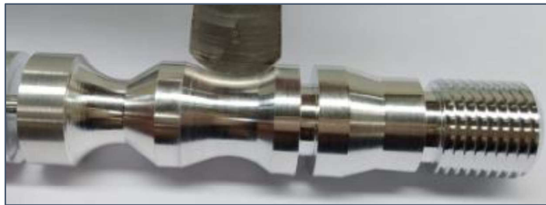
Figura 3.86. Pieza 1 mecanizada en aluminio. (Fuente: Propia)
