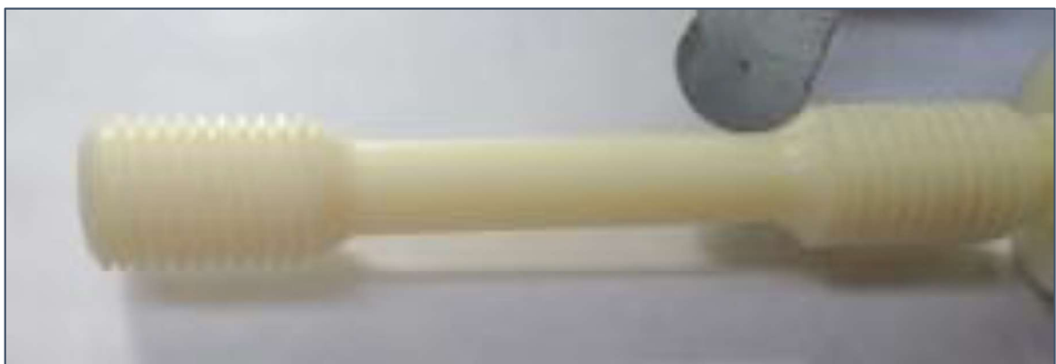
Figura 3.88. Probeta de tracción mecanizada en grilón. (Fuente: Propia)
