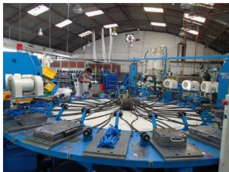
Figura 3.20. Proceso de inyección
